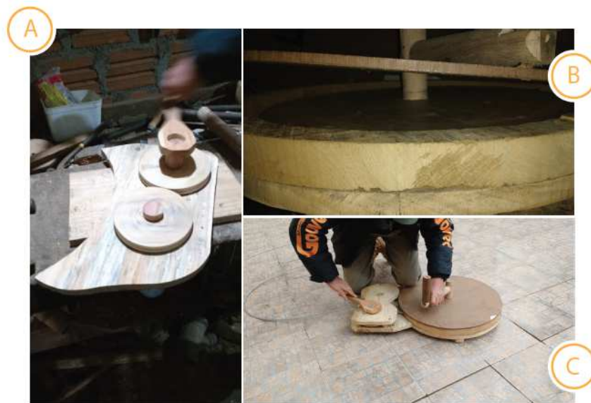
Figura 53 – Versão 03 do modelo de mecanismo de projeto: (A) Construção das polias, (B) adaptação do modelo 02 e (C) Versão 03 do modelo.
