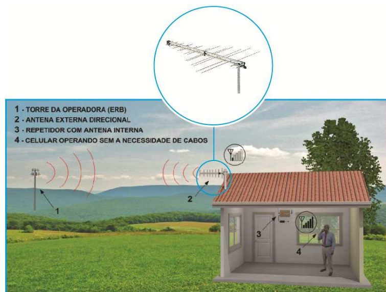
Figura 25 – Esquema apresentando como a antena rural capta o sinal.
