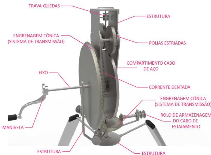
Figura 75 – Especificações dos componentes internos.
