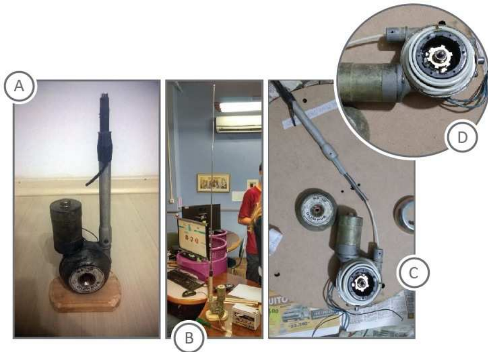
Figura 19 – (A) Antena compactada, (B) Antena estendida, (C) Parte interna da antena e (D) Detalhes da parte interna.
