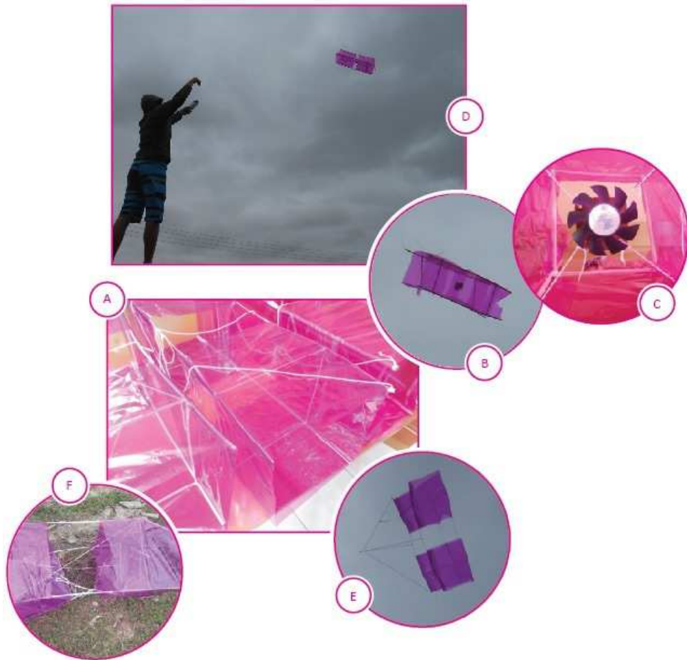
Figura 18 – (A) Pipas com diferentes materiais, (B) Pipa com estrutura em madeira roliça, (C) Estrutura do micro gerador eólico fixado na estrutura de madeira roliça, (D) Relação de altura homem x pipa, (E) Pipa com estrutura de fibra de vidro e (F) Pipa com estrutura polimérica.
