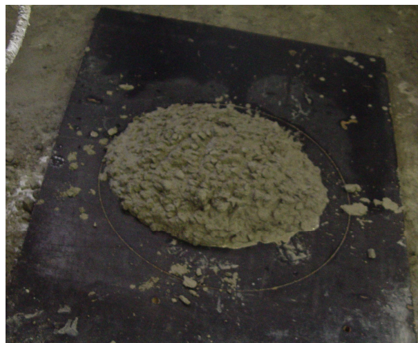
Figura 2.4: resultado de ensaio de espalhamento com concreto pouco fluido.
