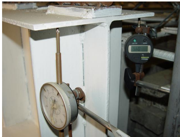
Figura 4.30: instrumentação do pórtico - relógios 3 e 4.
