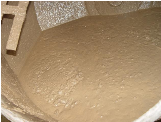
Figura 4.20: aparência do traço de CAA com \alpha = 60\% antes (a) e depois (b) da incorporação do aditivo VMA no traço.
