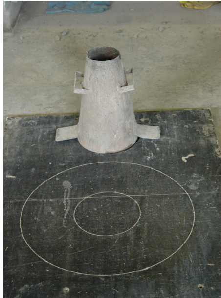
Figura 2.2: materiais para o ensaio de espalhamento.
