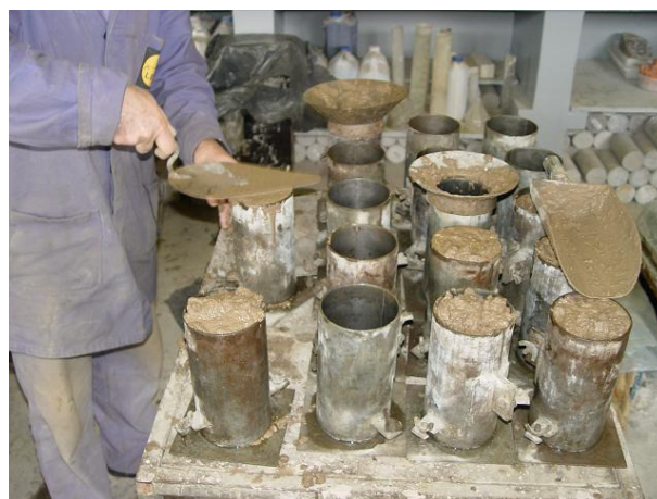
Figura 4.25: moldagem dos corpos-de-prova com concreto auto-adensável.
