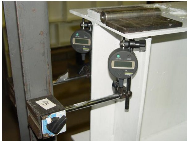
Figura 4.29: instrumentação do pórtico - relógios 1 e 2.
