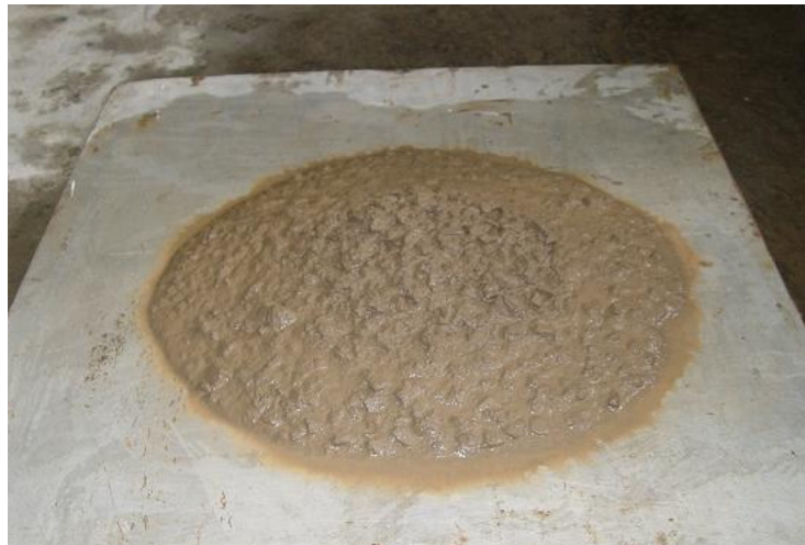
Figura 4.21: ensaio de Slump Flow Test realizado após correção do traço de CAA com \alpha = 60\% .
