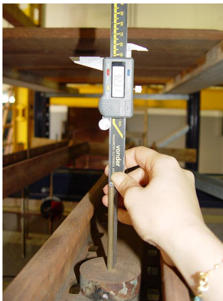
Figura 4.31: procedimento de leitura dos pinos metálicos 3 e 4.
