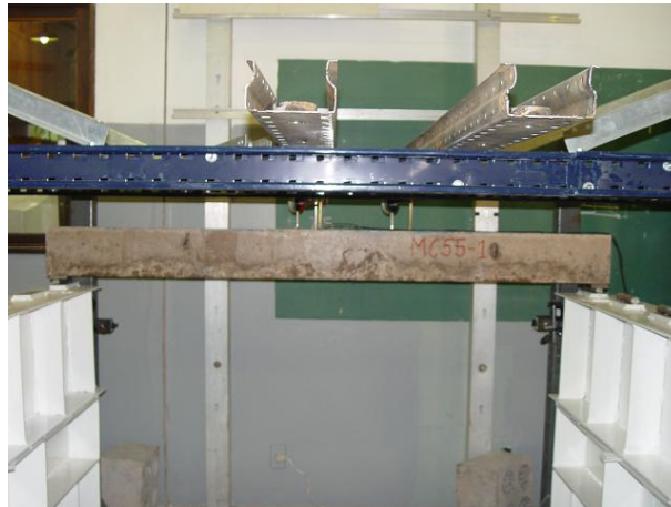
Figura 4.34: vista de uma das vigas após a desforma.
