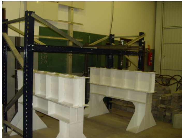
Figura 4.11 - pórtico de suporte das vigas – vista geral.
