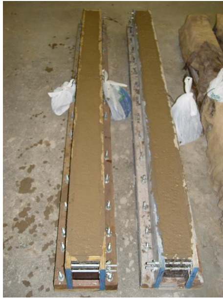
Figura 4.26: acabamento da superfície das vigas.
