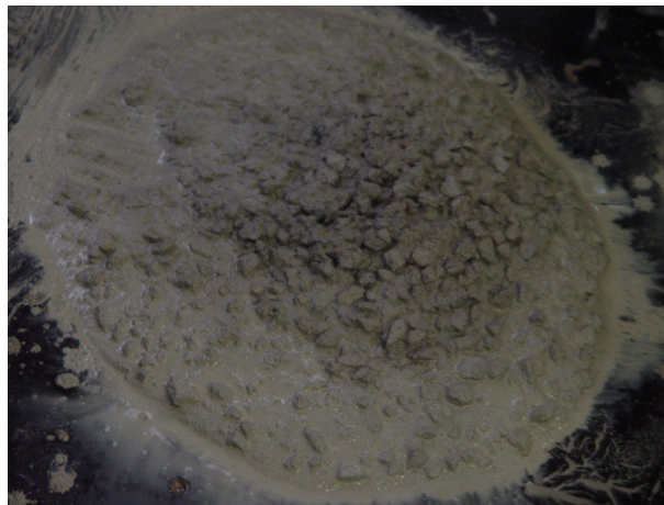
Figura 2.3: resultado de ensaio de espalhamento indicando concreto segregado.
