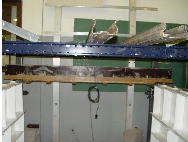
Figura 4.32: viga posicionada no pórtico de ensaio ainda com o restante da fôrma.
