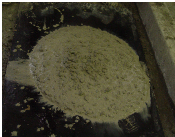
Figura 2.5: resultado satisfatório de ensaio de espalhamento.
