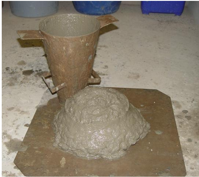
Figura 4.27: ensaio de abatimento de tronco de cone – CCV.
