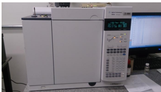
Figura 22: Cromatógrafo a gás Agilent 7890A
