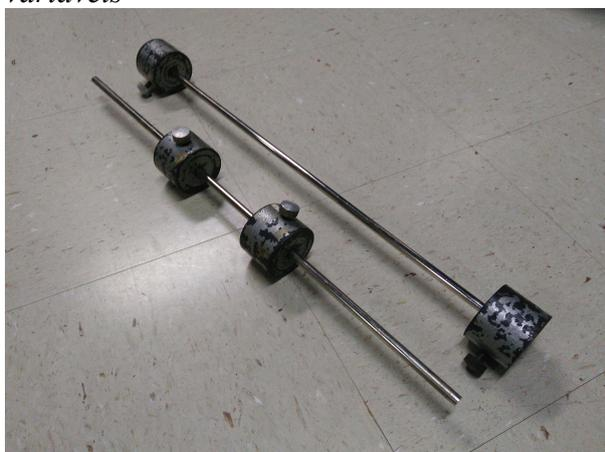
*Figura 4: Rolamentos com distribuição de massa diferentes*
