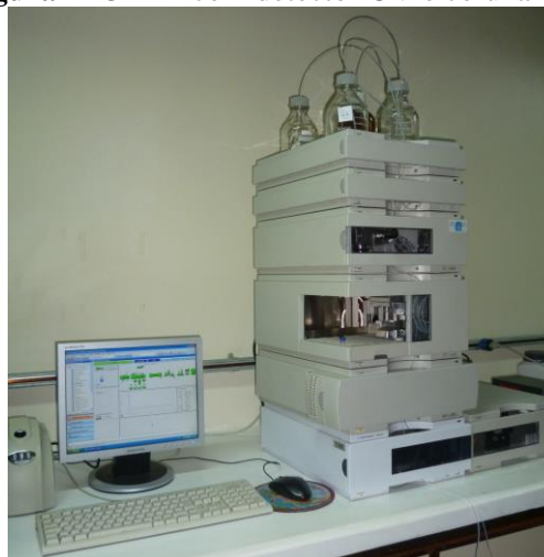
Figura 2- CLAE com detector UV e coluna C30.
