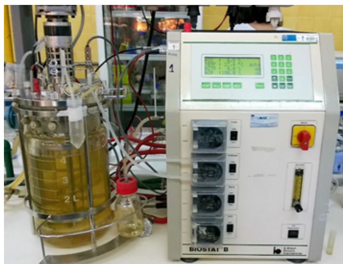
Figura 10 – Biorreator BIostat B™, com eletrodos de pH, oxigênio dissolvido e rotor acoplados à unidade de controle
