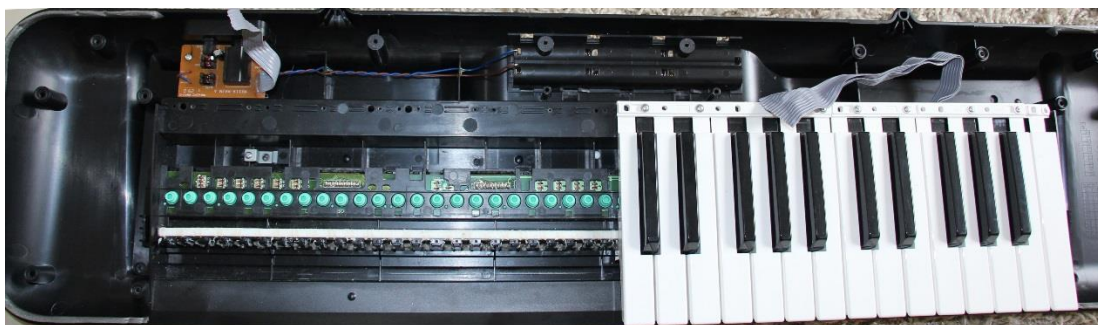
Figura 6-9 – Teclado Casio desmontado para investigação de como ler as teclas pressionadas
