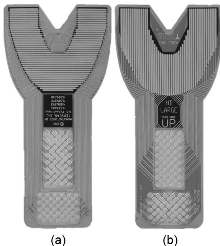
Figura 19. Foto do sensor T-SCAN®: (a) vista inferior e (b) superior.
