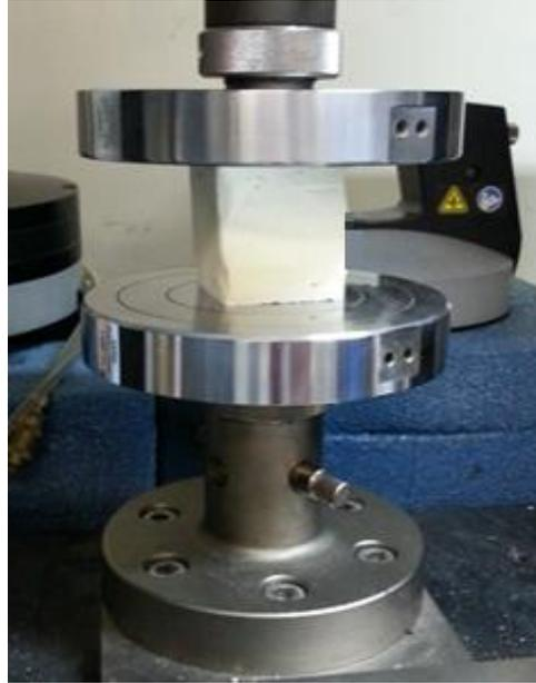
**Figura 25** – Ensaio de compressão do núcleo dos painéis.
