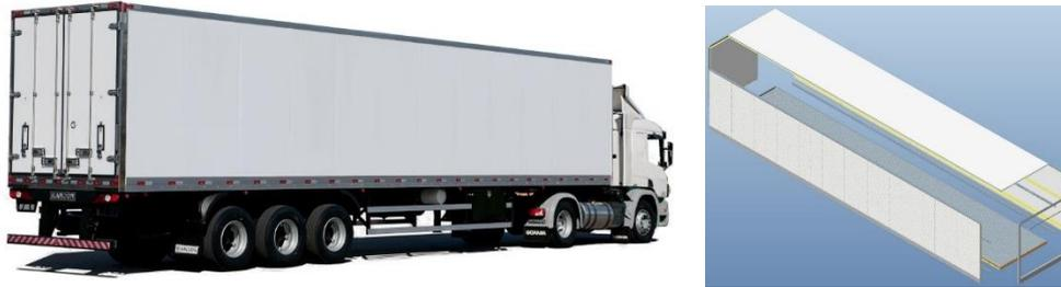
**Figura 16** – Carroceria termicamente isolada para transporte de alimentos perecíveis.
