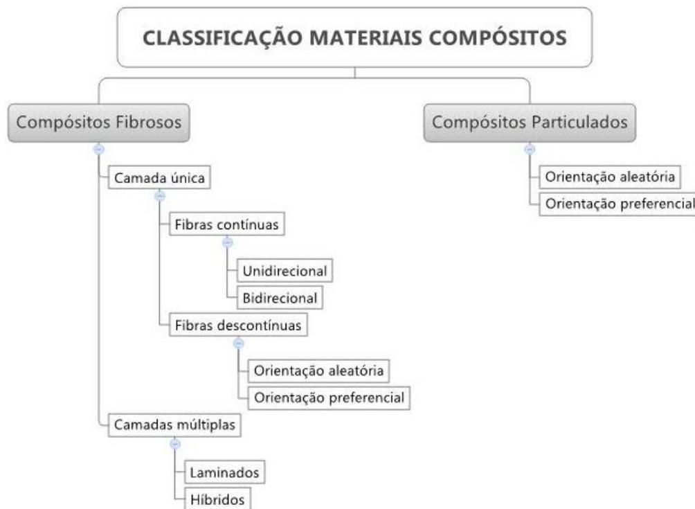
**Figura 1** – Classificação dos materiais compósitos com relação ao tipo de reforço utilizado (adaptado de Ventura, 2009).
