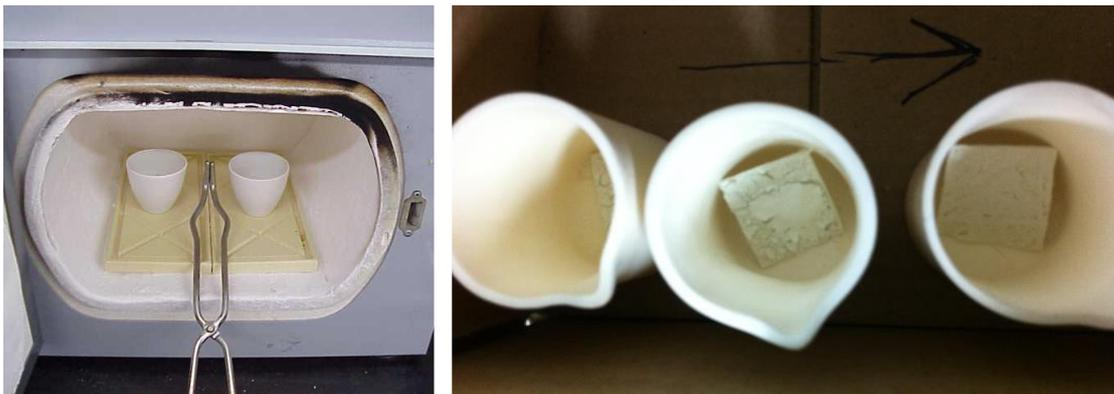
**Figura 22** – Mufla utilizada para determinação do teor de reforço com relação a massa em compósitos (a) e vista das amostras (b).
