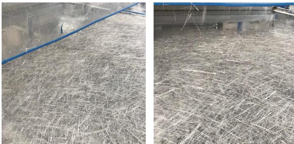
**Figura 18** – Processo de laminação contínua para compósito fabricado com manta.
