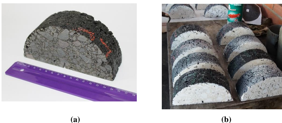
Figura 29 - Corpo de prova correspondente às dimensões especificadas (a) e posteriormente pintado (b)
