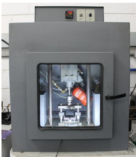
Figura 25 - Equipamento de ensaio para determinação de MR (Arquivos LAPAV, 2016)
