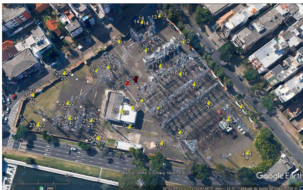
Figura 10 – Pontos de medição da subestação PAL10.
