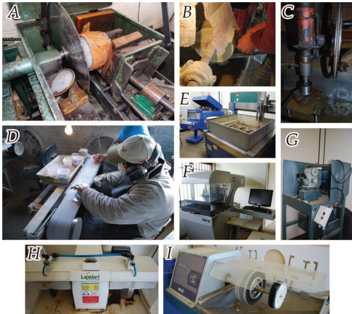
(A) serra diamantada para corte de chapas; (B) polimento com feltro de lã e abrasivo de pó de tripoli; (C) furadeira de bancada com serra copo diamantada; (D) lixa de mesa; (E) equipamento do CTPGJRS: corte por jato d'água, (F) gravadora laser (CTPGJRS); (G) cabocheira (CTPGJRS); (H) multi-machine serra e reboło diamantado (CTPGJRS); (I) multi-machine lixa e feltro de lã (CTPGJRS).
