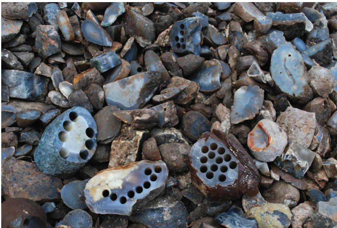
Figura 1 – Depósito de resíduos em indústria de beneficiamento de Soledade, onde podem ser observados vários fragmentos de geodos de ágata já beneficiados com um baixo aproveitamento. Os orifícios na ágata são feitos por serra copo diamantada de espessuras de aproximadamente 20 mm à 30 mm, utilizados para a confecção de cabos para talheres e outros utensílios.
