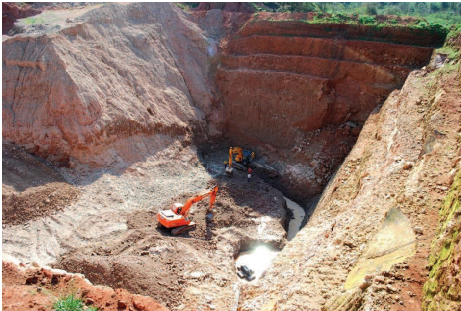
Figura 16 – Garimpo de extração de ágata em Salto do Jacuí/RS, com o maquinário trabalhando para exploração do material e a coleta manual dos geodos.
