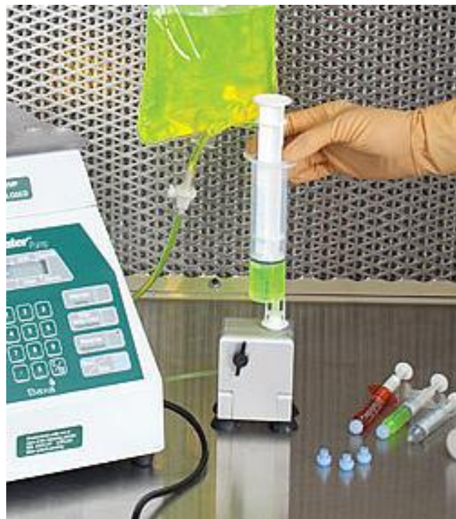
Figura 4 - Enchimento de seringa oral por bomba dispensadora automática RepeaterPump™ da Baxter.
