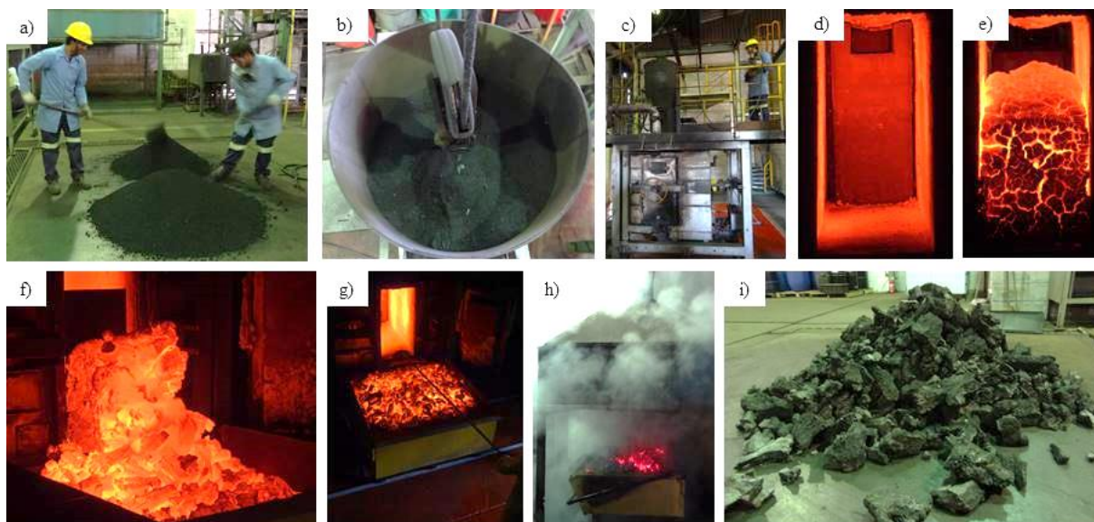
Figura 11 – Coqueificação em forno piloto: a) Homogeneização das misturas; b) Tremonha carregada e c) sendo posicionada para o descarregamento; d) interior do forno antes; e) e após o processo de coqueificação; f) e g) descarregamento do coque; h) apagamento do coque com água; i) coques produzidos.
