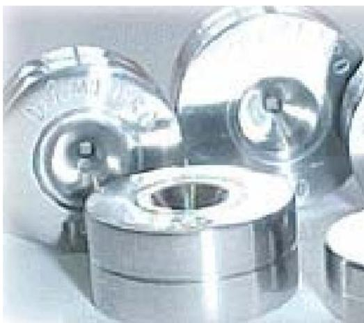
Figura 2.5 - Fieiras utilizadas na trefilação. Destaque para o orifício revestido de metal duro.
