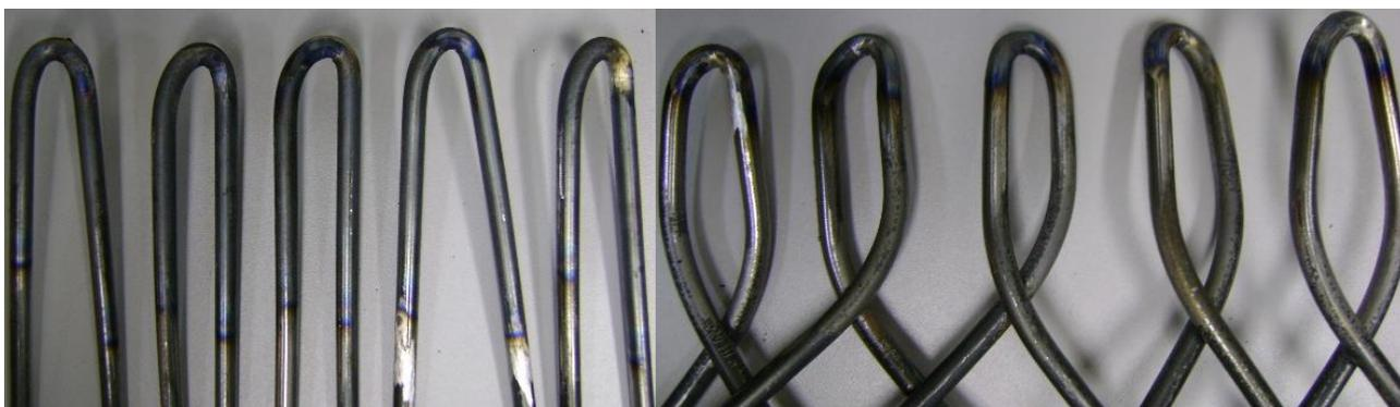
Figura 4.11 - CP's obtidos com posterior reaquecimento à esquerda e CP's obtidos com esmerilhamento agressivo à direita.
