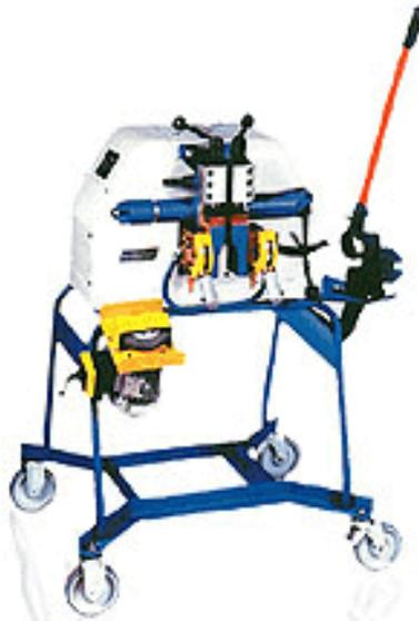
Figura 2.8 - Máquina de solda da marca Schlatter utilizada no processo estudado.
