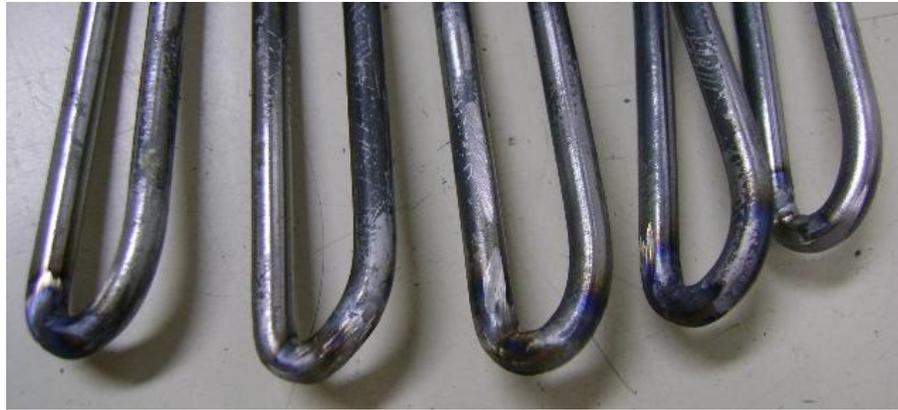
Figura 4.7 - CP's da primeira condição de soldagem dobrados.
