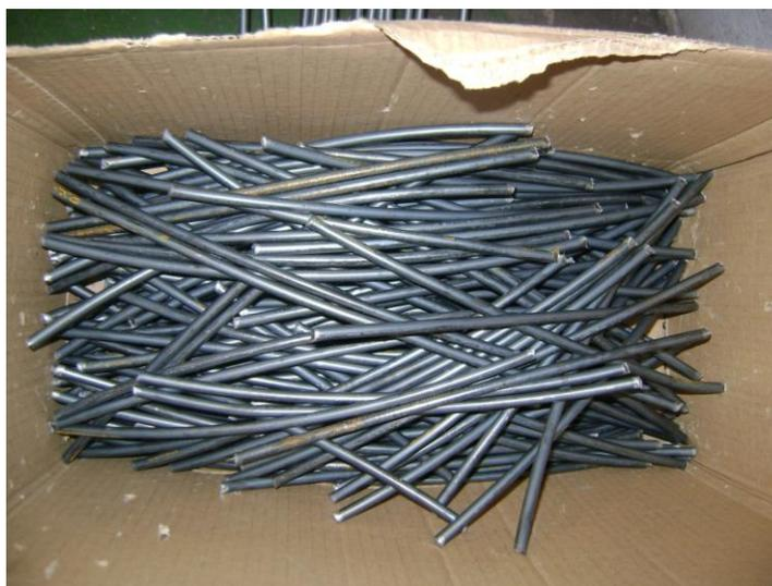
Figura 3.3 - Pedacos cortados com aproximadamente 250 mm de comprimento para confecção das amostras.
