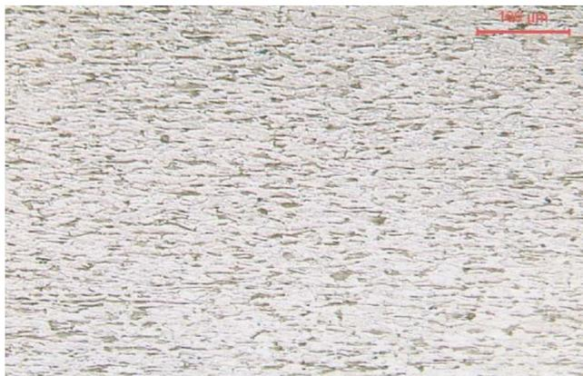
Figura 2.4 - Grãos alongados após o último passe, com uma deformação de 66%.
