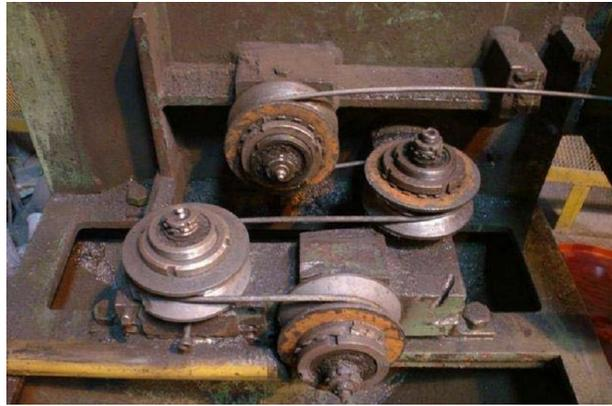
Figura 2.1 - Decapagem mecânica utilizada antes do primeiro passe no processo estudado.
