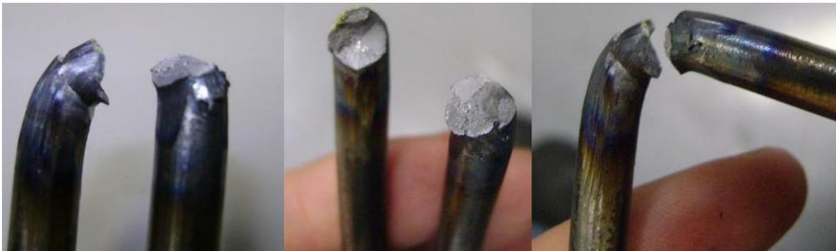
Figura 4.8 - CP quebrado após o teste de dobramento. É apresentada a face fraturada e a posição em que quebrou ( $120^\circ$ ).
