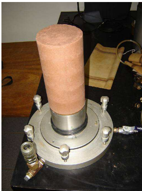
Figura 4.7 – Corpo de prova de solo residual de arenito Botucatu, compactado para ensaio triaxial.
