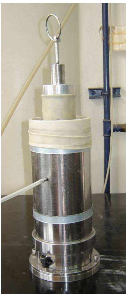
Figura 4.15 – Membranas interna e externa e moldes externo e interno do corpo de prova, posicionado no pedestal para o início da moldagem.
