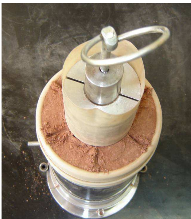
Figura 4.17 – Marcação da posição das palhetas no topo do corpo de prova antes da cravação da peça de topo.
