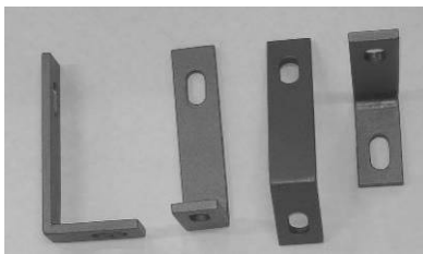
Canaletas de fixação dos cilindros pneumáticos
