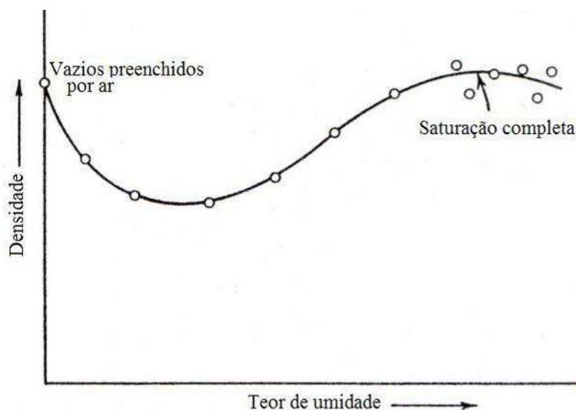
Figura 4.6 – Típica curva de compactação para areias sem coesão (Foster, 1962 apud Lambe e Whitman, 1979).
