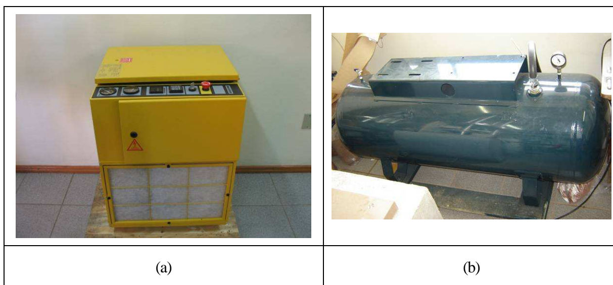
Figura 3.25 – Compressor de ar Kaeser SX 7 e reservatório Chiaperini de 360 l
