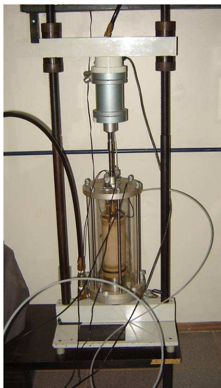
Figura 4.8 - Ensaio triaxial de carga repetida para determinação do módulo de resiliência em um corpo de prova compactado de solo residual de arenito Botucatu.
