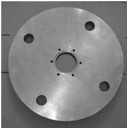
Placa circular superior em aço inoxidável
