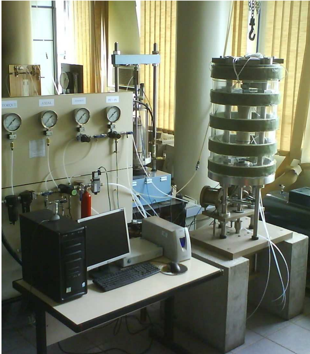
Figura 3.2 - Fotografia do layout geral do equipamento hollow cylinder torsional com o quadro pneumático e o sistema de aquisição automática de dados.
