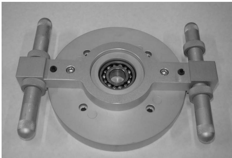
Figura 3.23 – Viga de torque fixada ao cabeçote de transferência de carga. No centro é acoplado o rolamento de dupla carreira de esferas.
