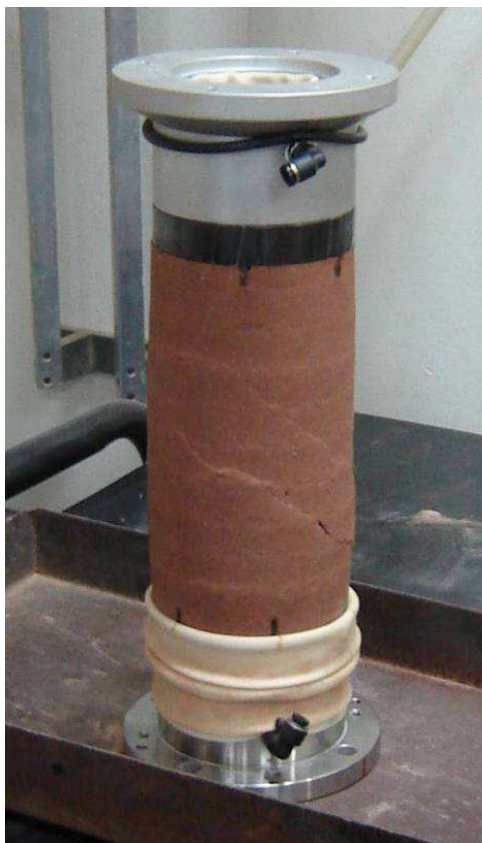
Figura 5.13 – Superfície de ruptura ocasionada pela aplicação de torque no ensaio EST4.
