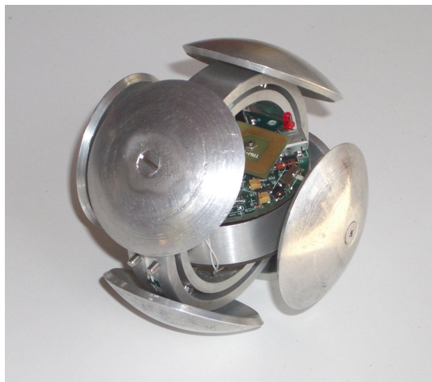
Figura 54: esfera instrumentada com extensômetros sem fios.
