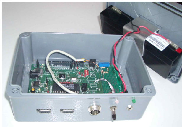
Figura 37: sistema de aquisição de dados com o EVM MSC1211.
