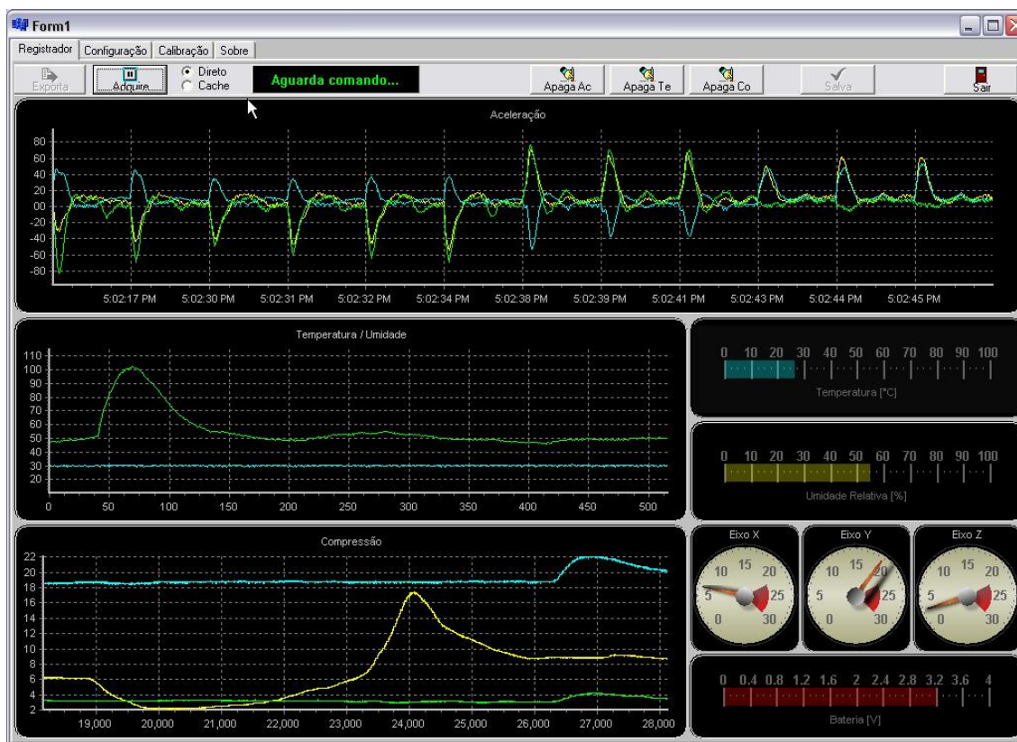
Figura 51: tela de registro de aceleração, compressão, temperatura e umidade do software.
