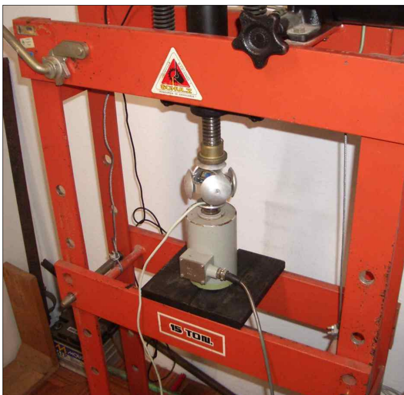
Figura 57: procedimento de calibração das células de carga.
