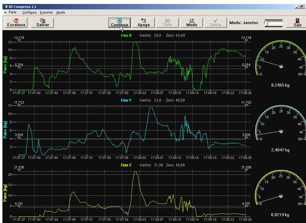
Figura 42: imagem da interface gráfica do software desenvolvido para análise de compressão.
