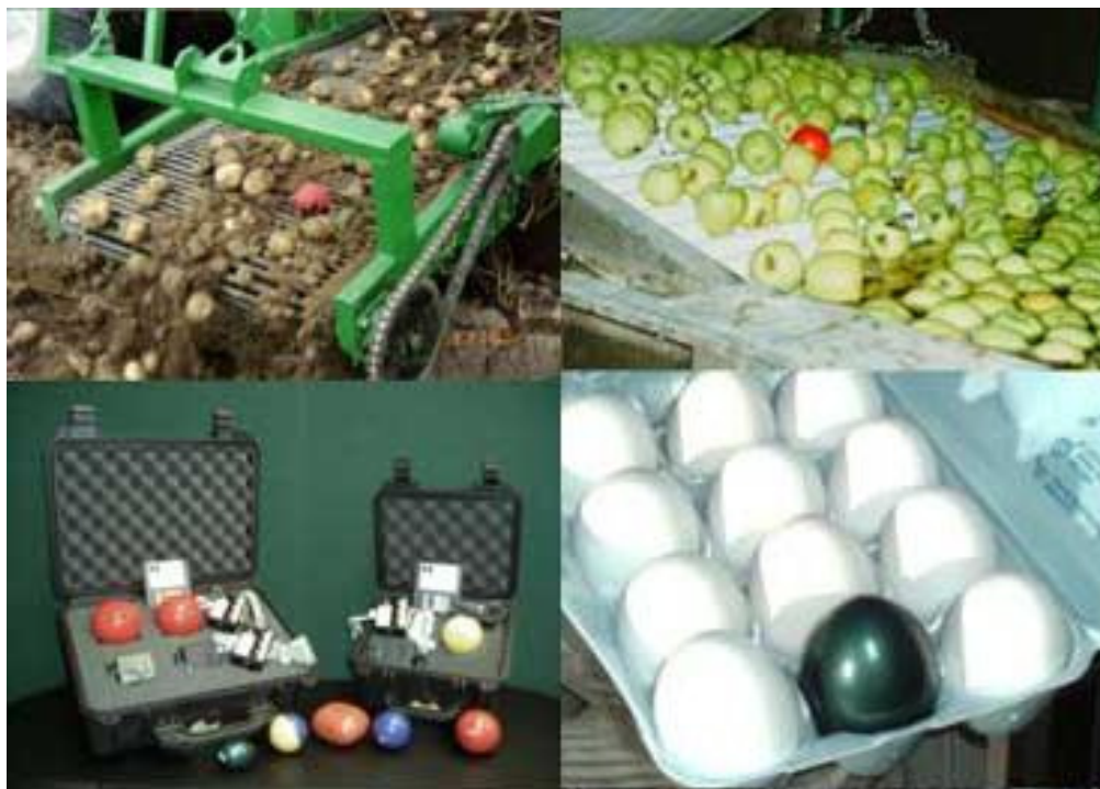
Figura 21: diferentes utilizações do IRD. No alto à esquerda, na triagem de batatas, à direita, durante a seleção de frutas e abaixo a direita, no empacotamento de ovos.
