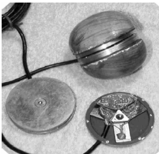
Figura 24: sensor desenvolvido para capturar a compressão vertical sofrida por frutas.
