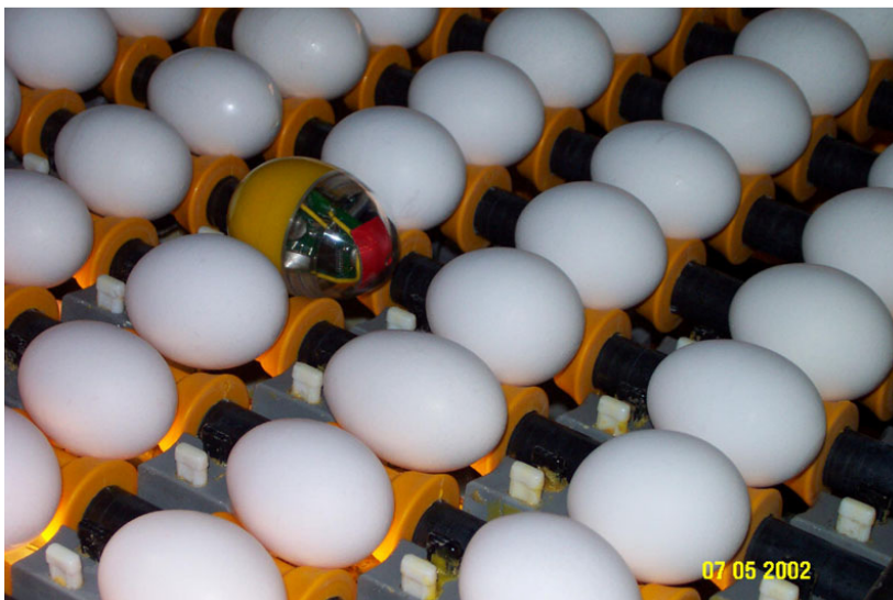
Figura 23: outra variação do instrumento desenvolvido pela empresa Sensor Wireless , o Crackless Egg , é visto na figura acima, captando as acelerações sofridas por ovos durante o processo de triagem.
