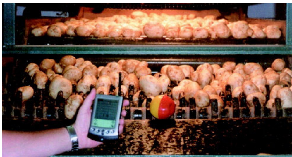
Figura 22: uma das variações do instrumento desenvolvido pela Sensor Wireless , o Smart Spud , é visto na figura acima, captando as acelerações sofridas por batatas durante o processo de triagem.
