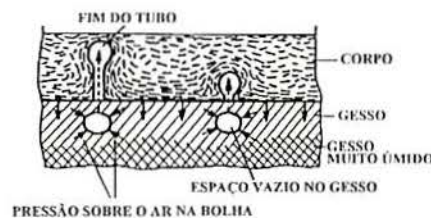
Figura 2.17: Bolhas em peça de alumina, provocada pelo excesso de água no molde. [Adaptado de "Handbook of Ceramics - Ceramics Monograph" - R. Herrmann, 1989].
