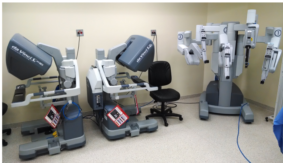
Figura 1: sistema robótico da Vinci SI dual console. Fonte: Arquivo pessoal
