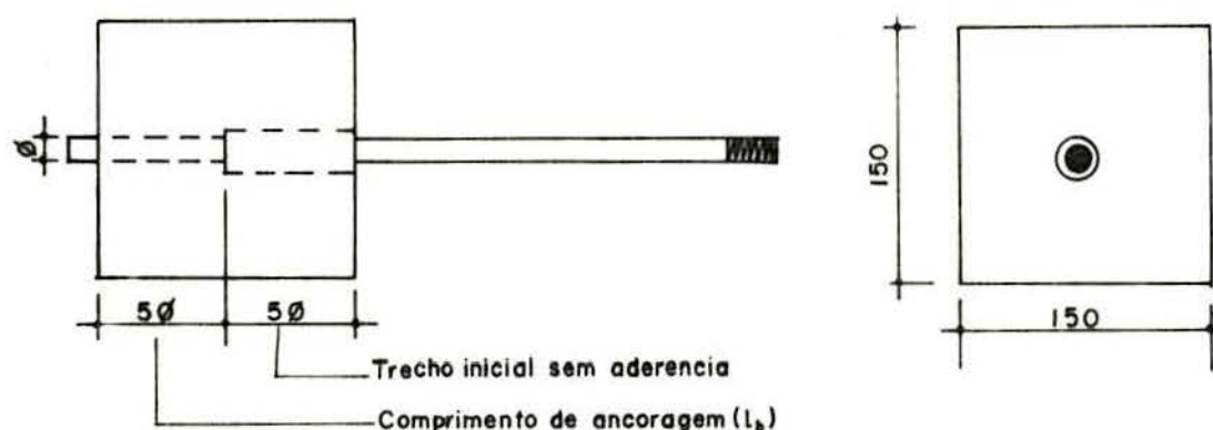
FIGURA 5.4. Dimensões dos CP utilizados nos ensaios de arrancamento direto.
