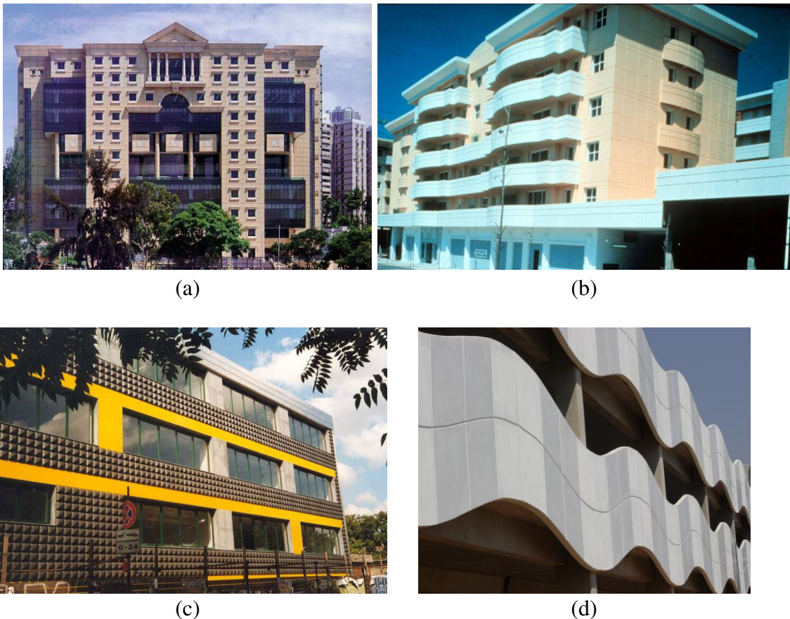
Figura 3.8: exemplos de edificações com fachadas constituídas de painéis pré-fabricados de GRC. (a) biblioteca central de Hong Kong (GRCA, 2005); (b) residência olímpica em Barcelona (GRCA, 2005); (c) Universidade Politécnica de Milão (GRC-GROUP, 2006); (d) detalhe da fachada da ULBRA Canoas/RS (ENFOQUE, 2005)
