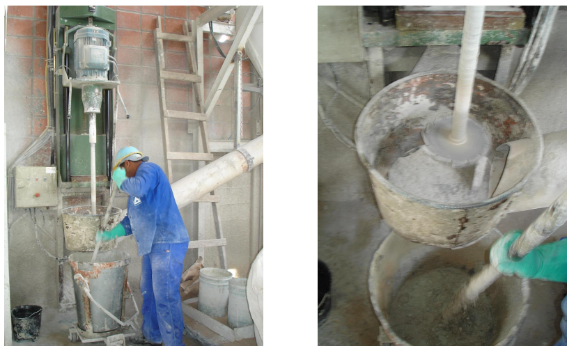
(a) (b) Figura 4.2: misturador de alta velocidade utilizado na produção das matrizes cimentícias, (a) vista frontal e (b) vista superior
