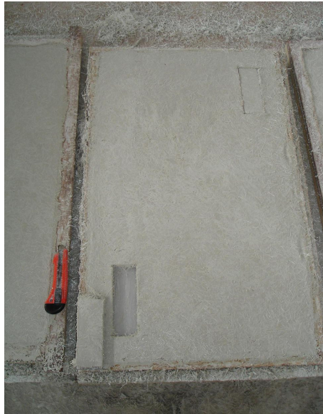
Figura 4.5: retirada dos corpos-de-prova da placa no estado fresco para a verificação do teor de fibras
