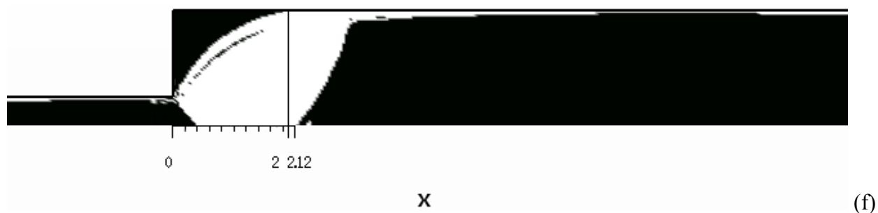
Figura 4.4 Escoamento através de uma expansão planar 1:4 – iso-regiões de \tau , para n=0,37 , K=1 Pa.s n e m=10^3 : (a) HB=0,1, (b) HB=1, (c) HB=10, (d) HB=20, (e) HB=50 e (f) HB=100.
