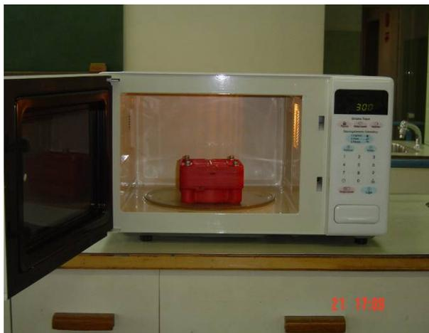
Fotografia 6. Mufla dentro do forno de micro-ondas para a polimerização
