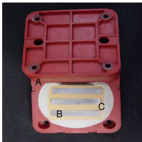
Fotografia 9. Mufla de fibrocerâmica(A) com matriz de aço (B) incluída em molde silicone (C)
