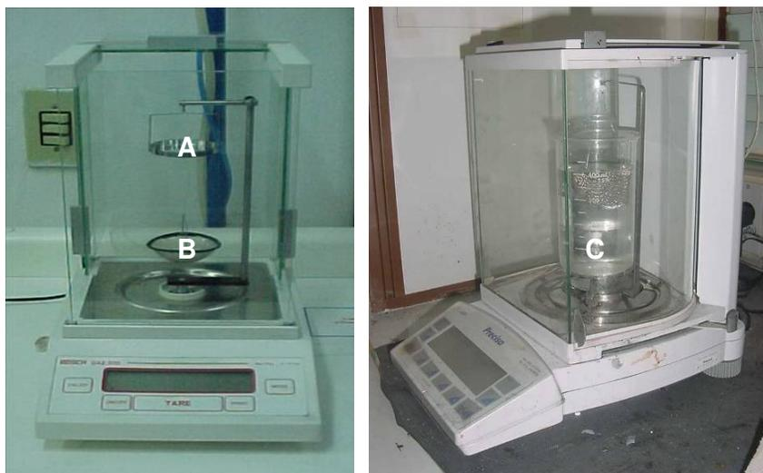
Fotografia 13. Balança de precisão usada no ensaio de determinação da massa específica
