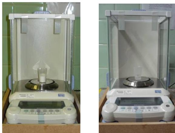
Fotografia 2. Determinação da massa do pó e do líquido em balança de precisão
