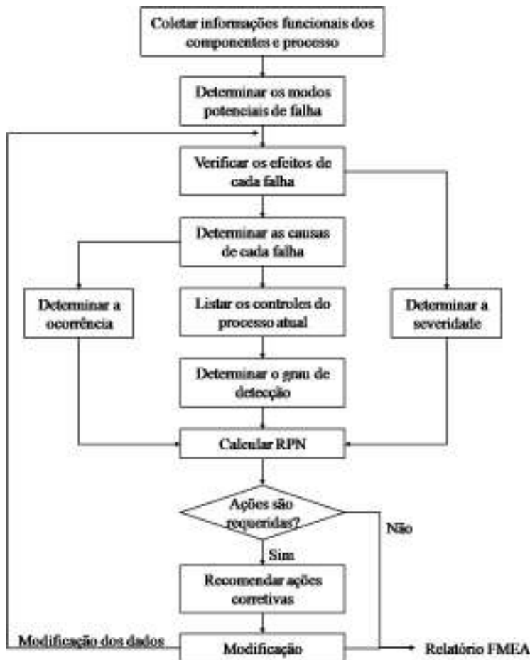
Figura 22: Procedimento geral de FMEA FONTE: adaptado de Teng e Ho (1996).
