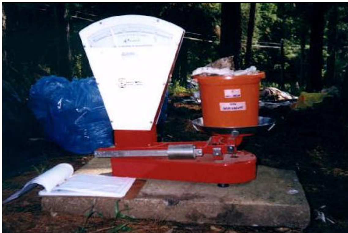
Figura 4.7- Pesagem dos materiais separados durante a caracterização
