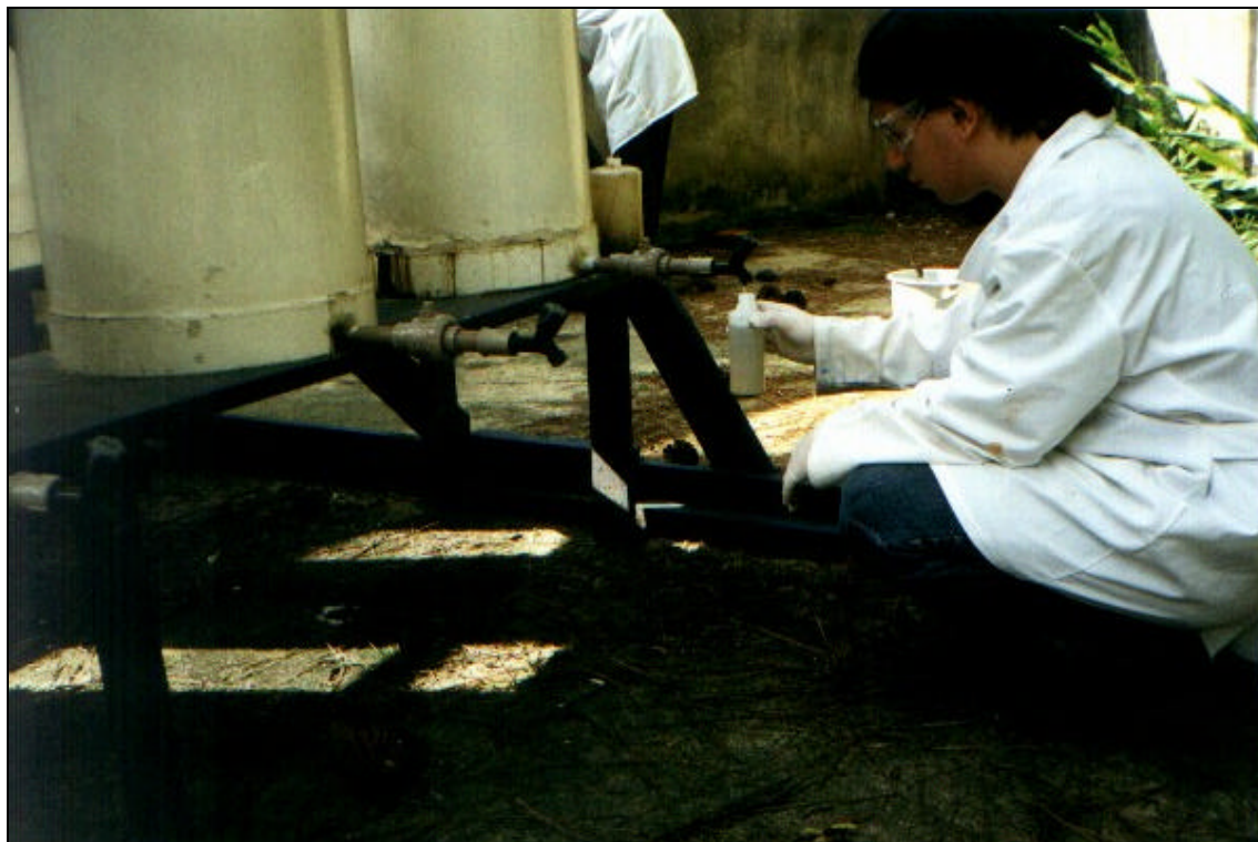
Figura 4.13 - Coleta do percolado na base do reator
