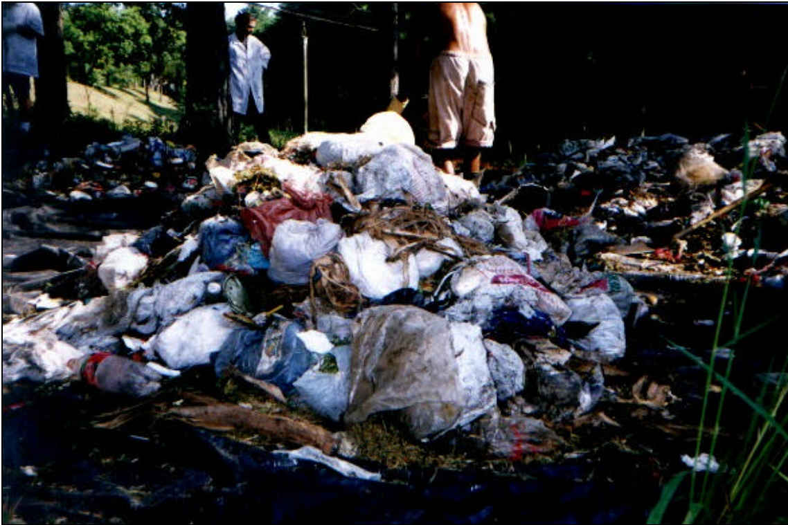
Figura 4.5 – Amostra a ser caracterizada, resultante do quarteamento
