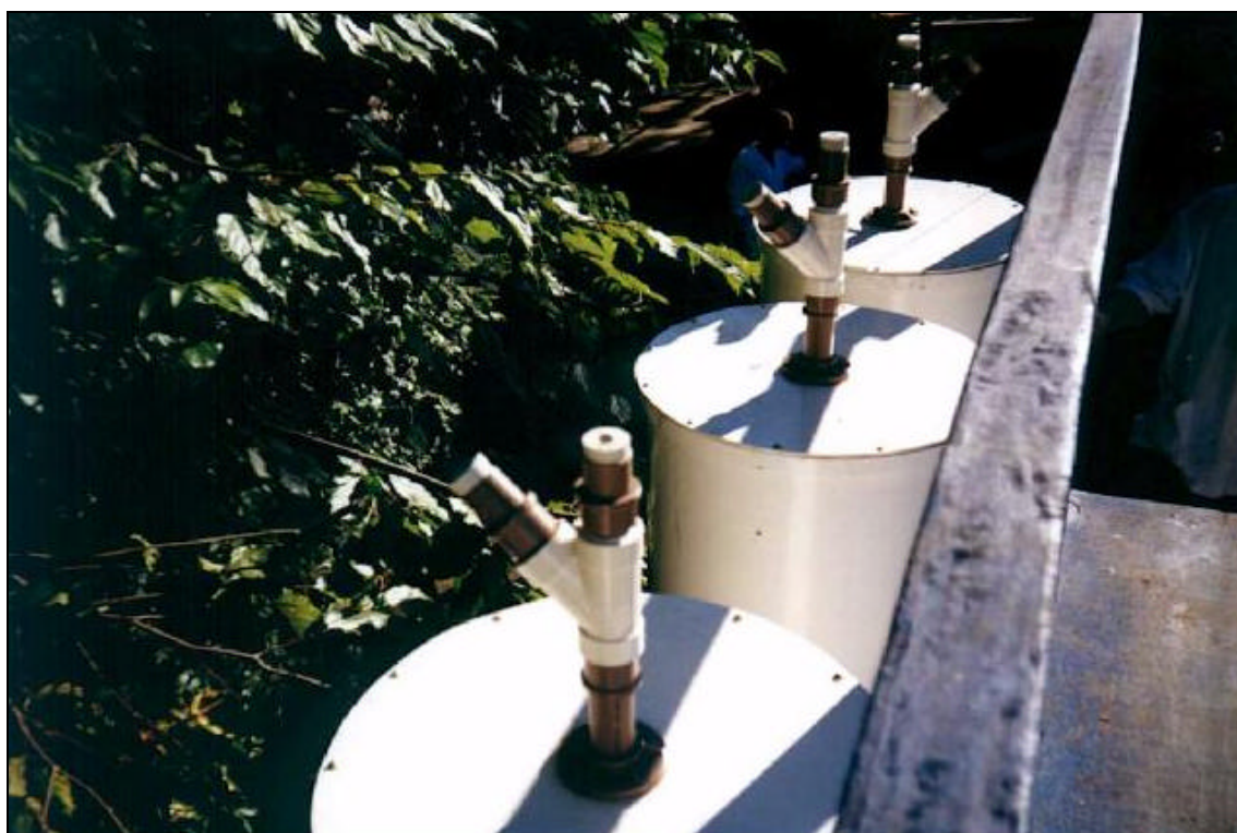
Figura 4.8 - Junção para entrada de líquido e saída de gases dos reatores
