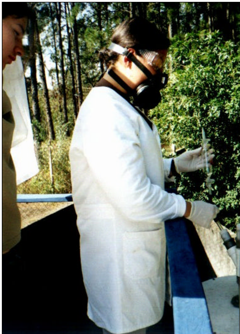
Figura 4.14 - Coleta de gases no topo do reator
