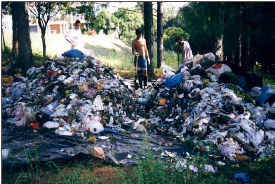
Figura 4.3 - Início do quarteamento da massa de RSU
