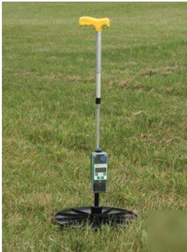
Figura 4 – Disco medidor de forragem, “Rising Plate”. INIA 2016
