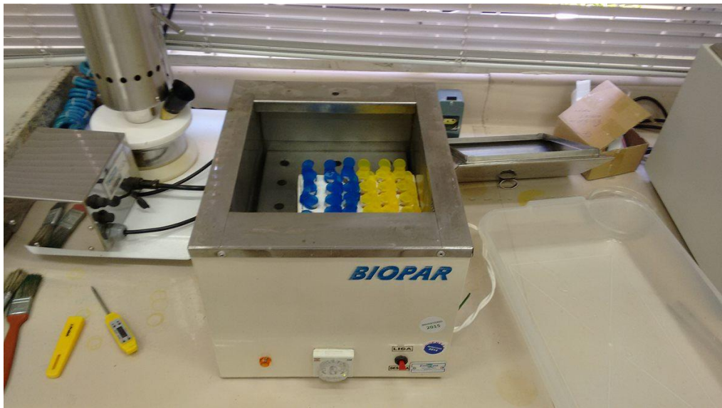
Figura 6. Amostras maceradas de ramos videira com \alpha -amilase, colocadas em banho-maria à 80°C, para que a enzima atue sobre o material.
