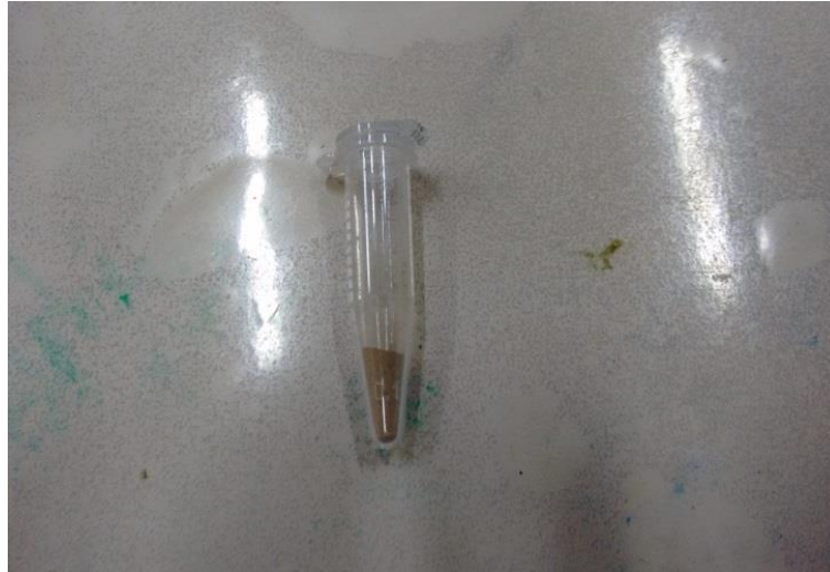
Figura 3. Tubo Eppendorf com amostra de ramos de videira macerados para efetivar a extração de monossacarídeos solúveis.
