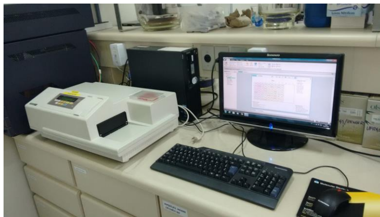
Figura 7. Equipamento empregado na leitura do espectro de cores das amostras, para determinar a quantidade de glicose.
