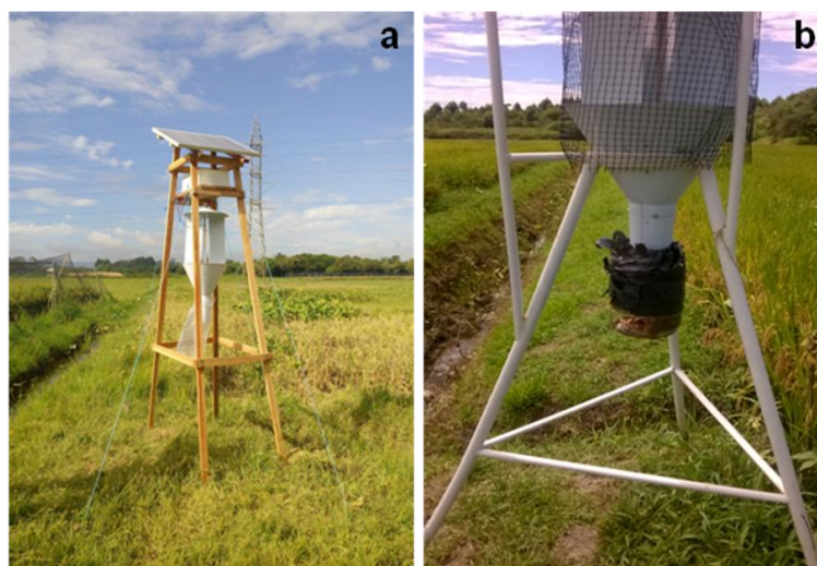
Figura 7. Armadilha Sonne com o saco coletor de insetos (a), armadilha Sonne com o aparato de contaminação fúngica de insetos acoplado (b).
