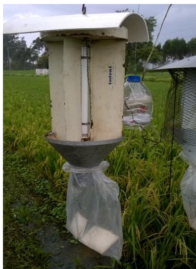
Figura 5. Armadilha luminosa com saco plástico para a coleta dos insetos utilizados no bioensaio.
