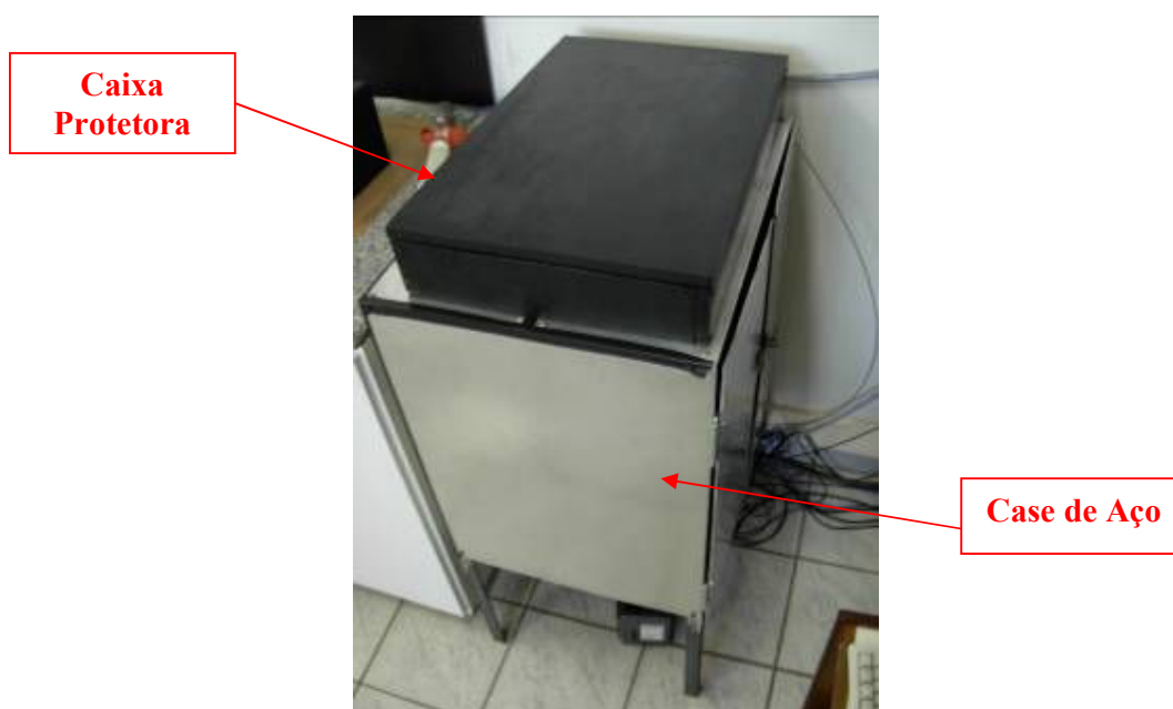
Figura 4-5 - Sistema para as medidas de adsorção: case de aço (contendo os cilindros de armazenamento de hidrogênio) e a caixa (superior) contendo as válvulas de controle.
