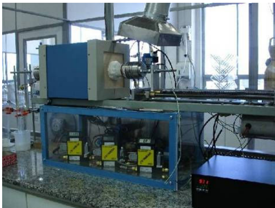
Figura 4-3 - Reator de DQVC utilizado neste trabalho para a síntese de NTC.
