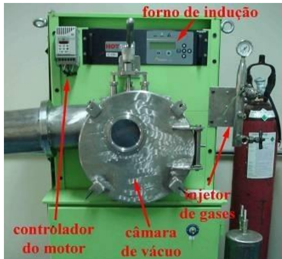
Figura 13. Foto mostrando os componentes externos do melt spinner construído no Eletrocorr/UFRGS.
