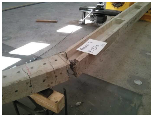
Figura 31: Ruptura do poste.
