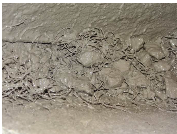
Figura 61: Traço com 1% de fibra e somente com brita 0.
