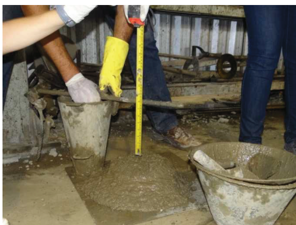
Figura 17: Execução do ensaio de abatimento de tronco de cone
