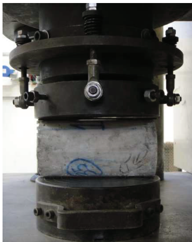
Figura 19: Execução do ensaio de resistência à tração por compressão diametral.
