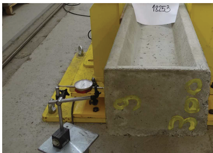
Figura 23: Verificação da condição e engastamento.
