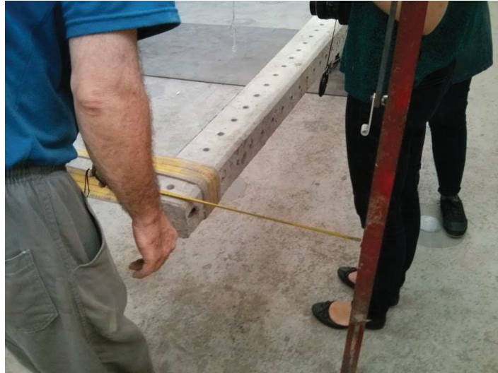
Figura 30: Determinação da flecha nominal.
