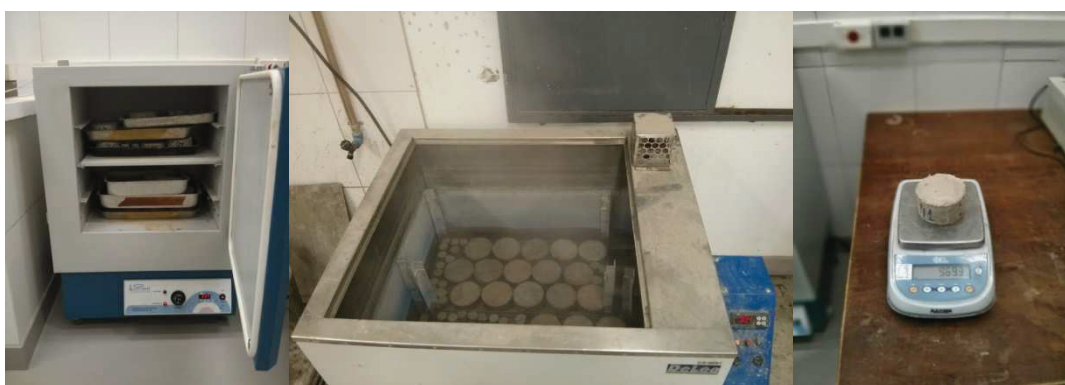
Figura 34: Execução do ensaio de absorção, índice de vazios e massa específica.
