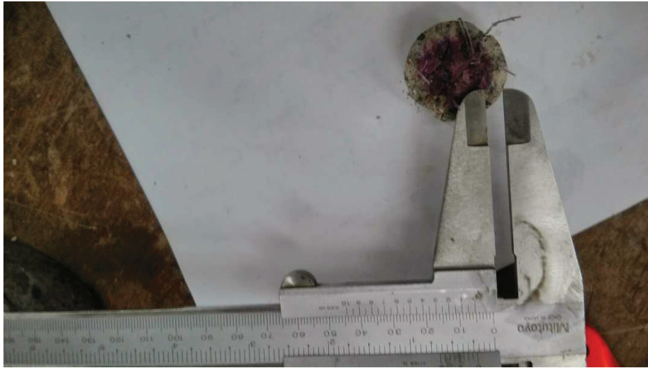
Figura 38: Determinação da profundidade de carbonatação.
