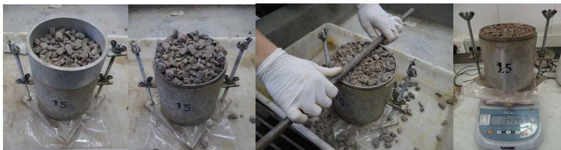
Figura 44: Passos para a determinação da massa unitária compacta
