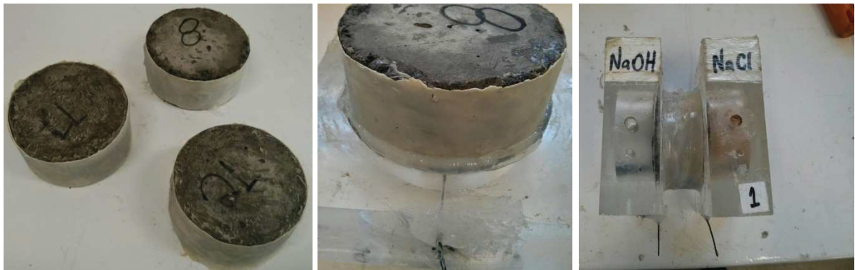
Figura 35: Preparação dos corpos de prova para ensaio de penetração de íons cloreto.
