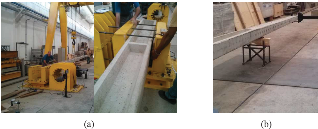
Figura 22: Posicionamento do poste na bancada de ensaio (a) e posicionamento do carrinho de apoio (b).
