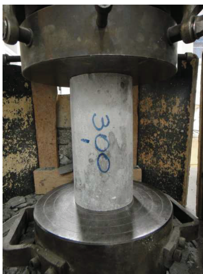
Figura 18: Execução do ensaio de resistência à compressão
