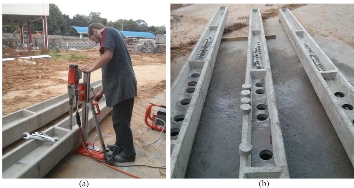
Figura 32: (a) Posicionamento do equipamento e extração dos corpos de prova b) e corpos de prova extraídos.
