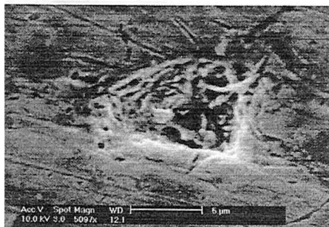
Figura 13: Aspecto de um pite formado por solução de Na_2S 0,02 M com pH 11
