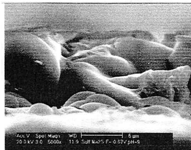
Figura 27: Vista de perfil da superfície do aço API T95, após 24 hs em \text{Na}_2\text{S} 0,02M, pH 9, e E_{\text{APLIC}} = -0,67 \text{ V}_{\text{ECS}}
