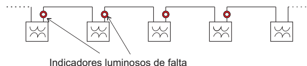
Figura 34: Indicadores luminosos de falta de sistemas subterrâneos
