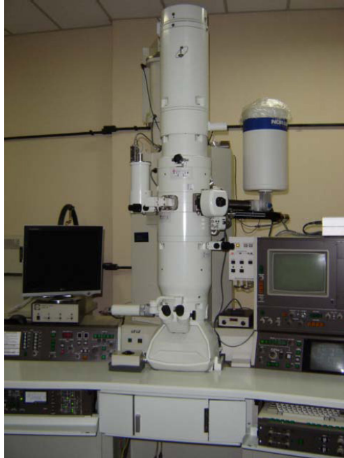
Figura 2.19 – TEM JEOL 2010 do Centro de Microscopia Eletrônica da UFRGS.
