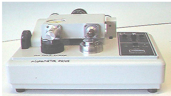
Figura 2.21 – Equipamento dimpler , utilizado nas preparações de amostras.
