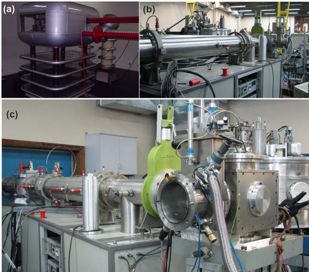
Figura 2.2 – Implantador HVEE 500 kV do Laboratório de Implantação Iônica do Instituto de Física da UFRGS. Em detalhe: (a) a fonte de tensão, (b) setor de aceleração e (c) câmara de implantação.
