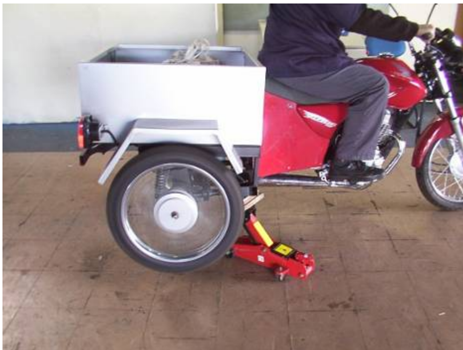
Figura 3.22 Verificação da funcionalidade do diferencial.
