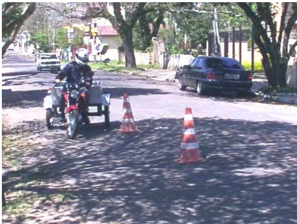
Figura 3.23 Ensaio do triciclo em pista para dirigibilidade.
