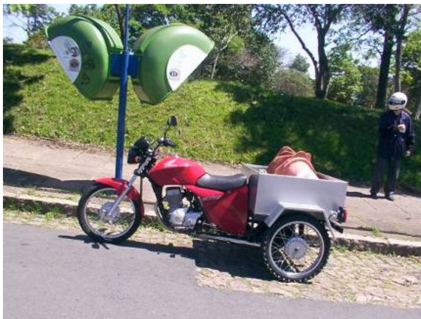
Figura 3.25 Ensaio do freio de estacionamento em rampa.
