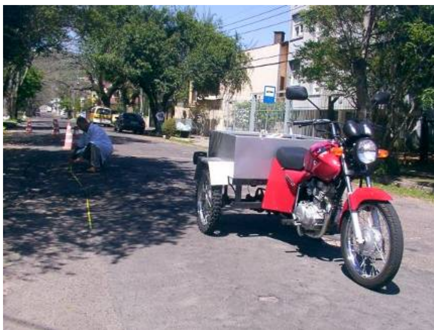
Figura 3.24 Medição da distância percorrida para frear o veículo a 80km/h.
