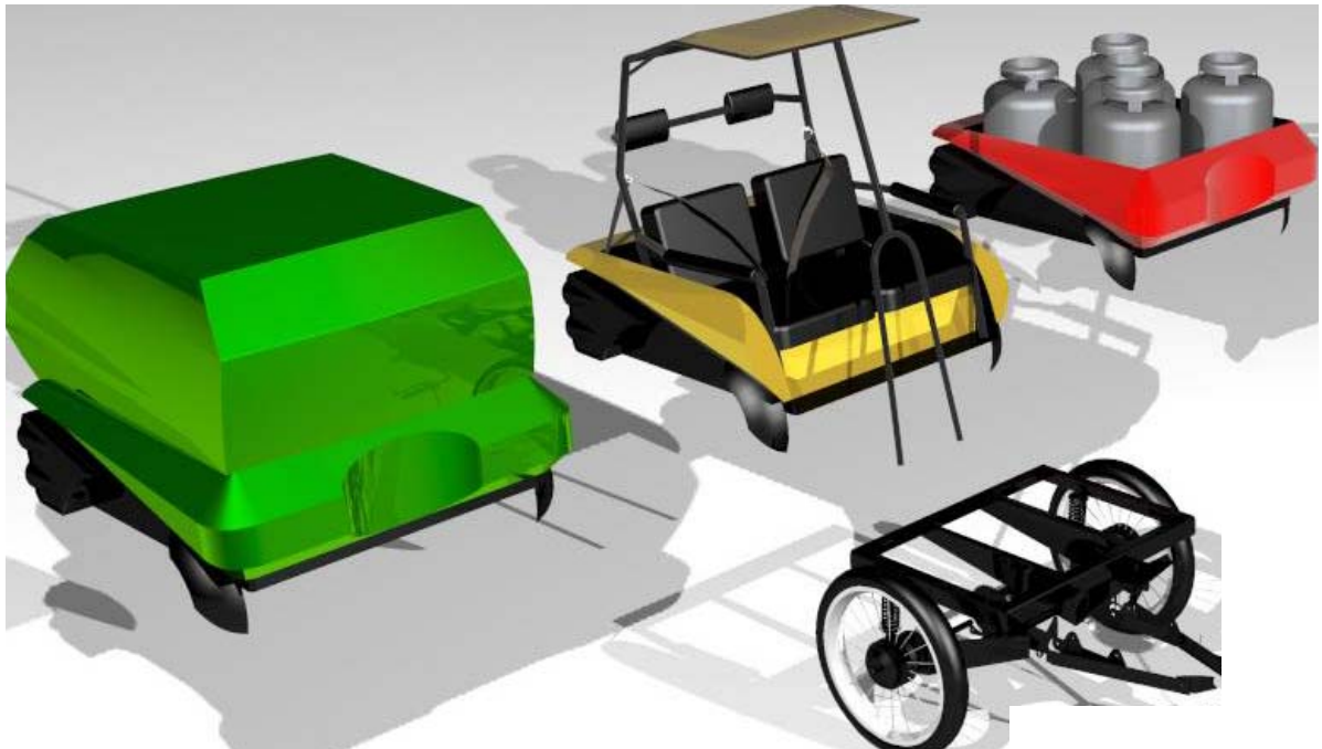
Figura 3.36 Versões básicas para carroceria do triciclo: baú (esquerda), passageiro (centro), caçamba (direita).
