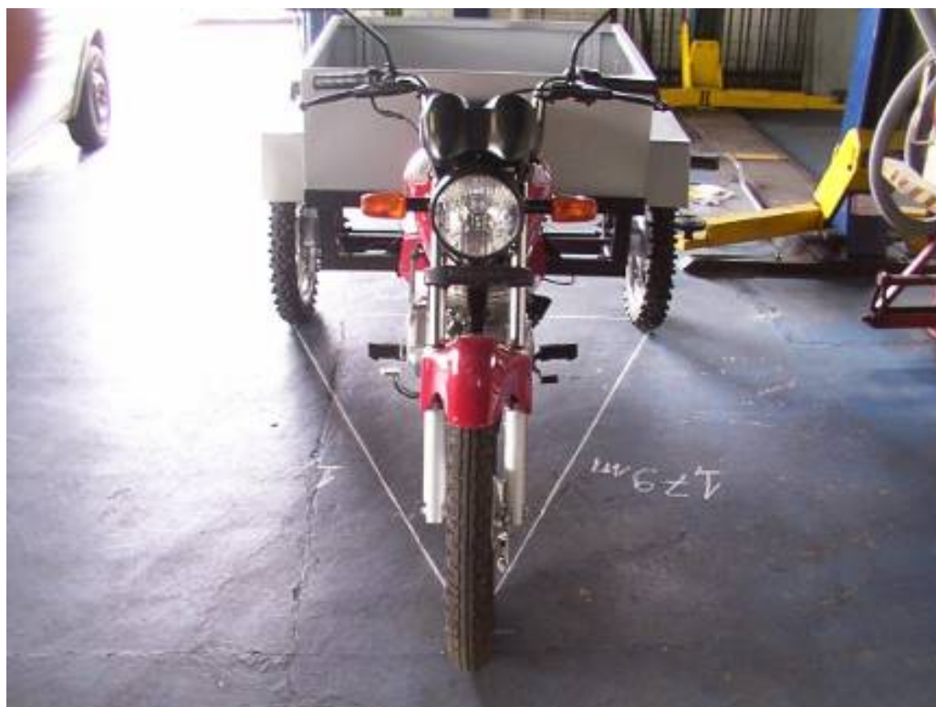
Figura 3.19 Verificação do alinhamento das rodas, CATERG.
