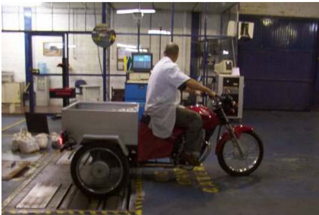
Figura 3.18 Ensaio do sistema de suspensão e freio dinamômetro de inércia do CATERG.
