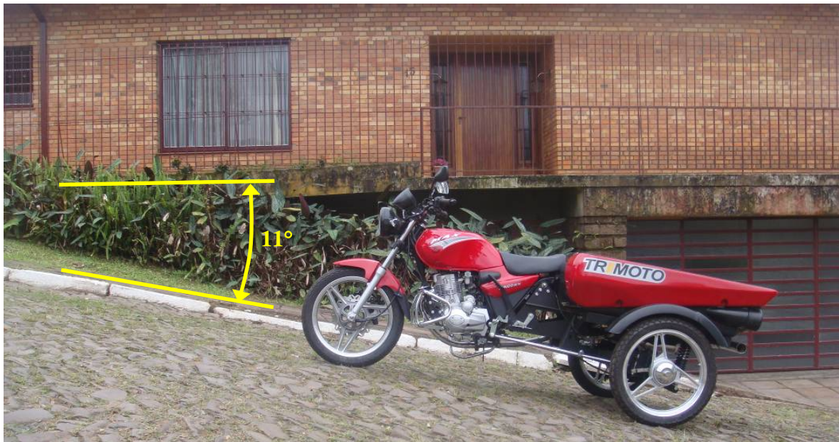
Figura 4.3 Teste de tração em via com 11^\circ de inclinação.
