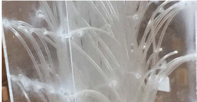
Figura 2.11 – Tomadas de pressão em um modelo rígido
