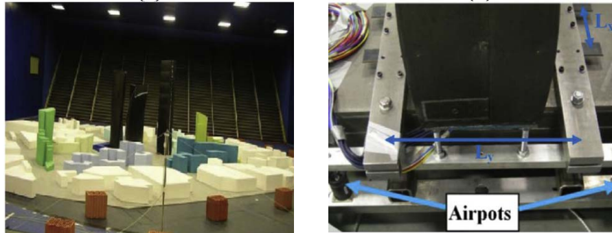
Figura 2.12 – Modelo aeroelástico e suporte elástico utilizado na parte inferior do modelo (baseada em ALY, 2014, p. 211)
