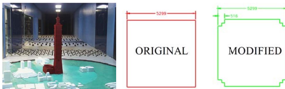
Figura 1.1 – Experimento em túnel de vento do Taipei 101 e seções transversais original e modificada, respectivamente (baseada em IRWIN, 2008, p. 703-704)
