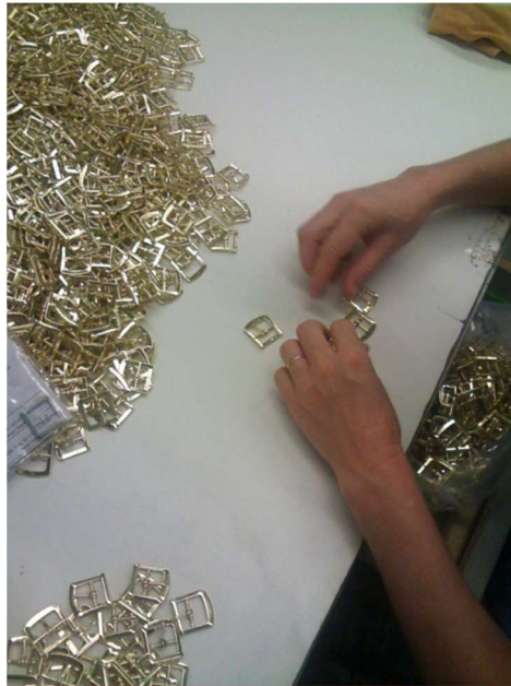
Figura 24 – Processo de inspeção visual
