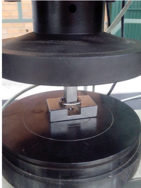
Figura 19 – Ensaio de compressão realizado na fivela
