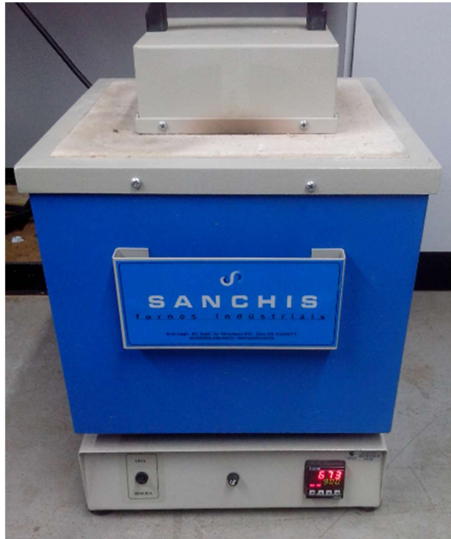
Figura 11 – Forno usado para fusão controlada das peças
