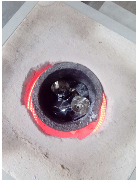
Figura 10 – Interior do forno de fusão com amostras de peças B1
