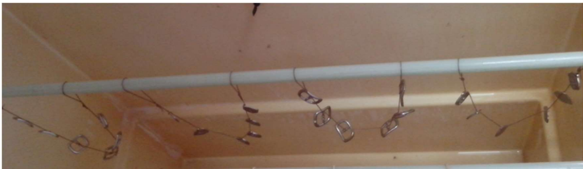
Figura 20 – Câmara de Salt Spray com as peças em seu interior
