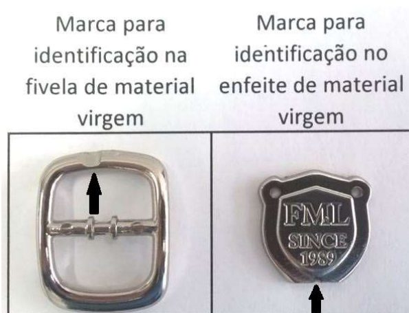
Figura 16 – Marcação na fivela e no enfeite, ambos produzidos com material virgem
