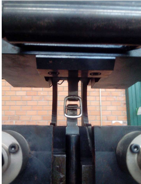
Figura 18 – Ensaio de tração da fivela
