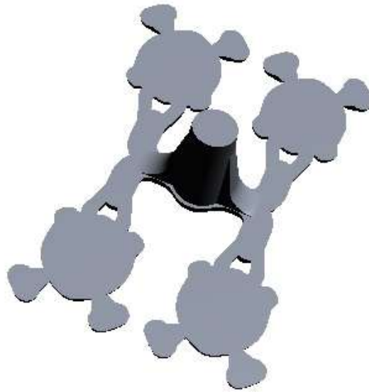
Figura 15 – Modelamento 3D do enfeite com canal e massalotes
