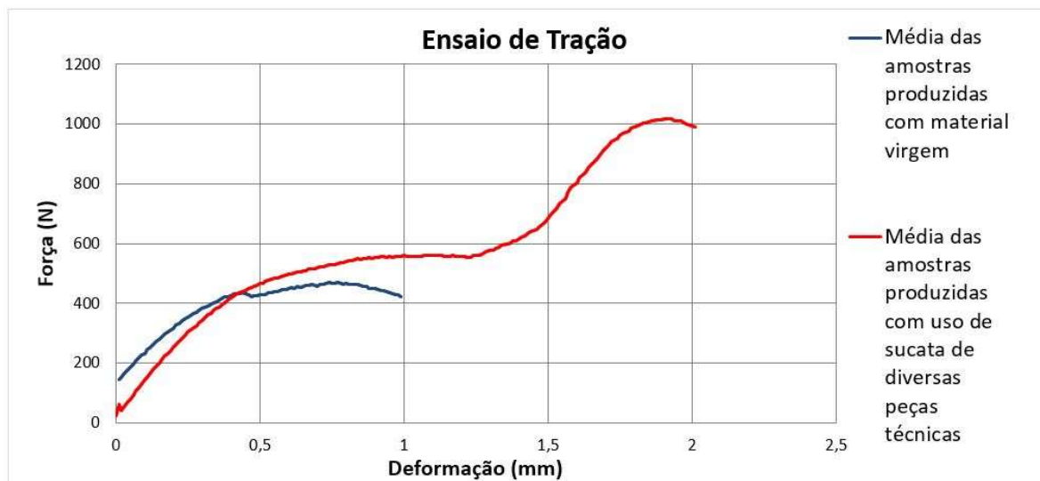
Figura 33 – Gráfico do ensaio de tração das fivelas de material virgem e de sucata
