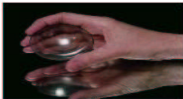
Cúpula hemisférica de diamante CVD, com 75mm de diâmetro e 2mm de espessura.
