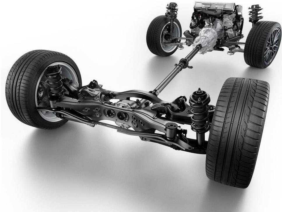
Figura 1.1 – Sistema de suspensão passiva independente nas quatro rodas de um automóvel de passeio
