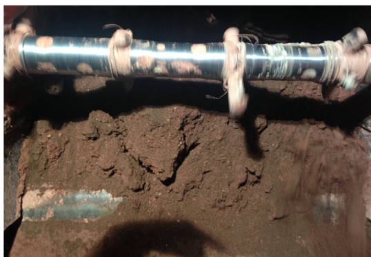
Figura 13: Processo de mistura da massa cerâmica
