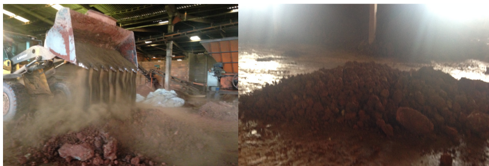
Figura 26: Resíduo sendo homogeneizado com a massa cerâmica
