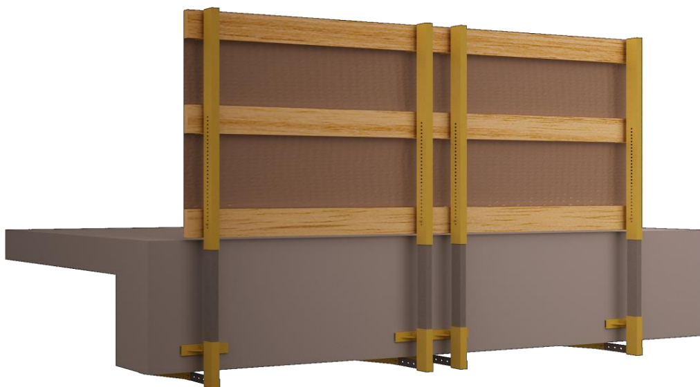
Figura 46. Recomendação. SPP instalado.
