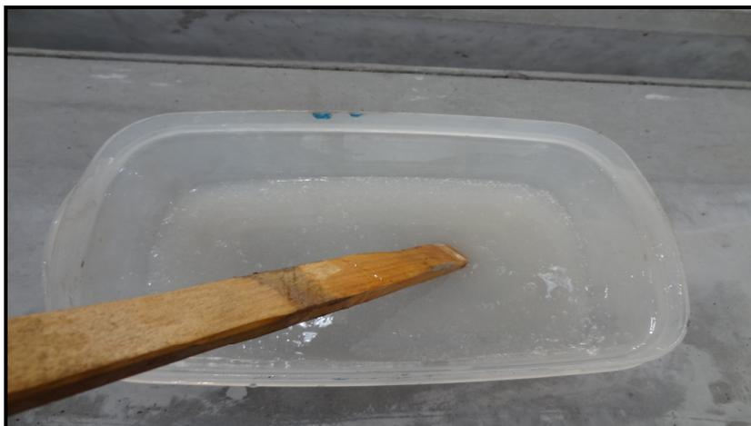
Figura 3.50 – Mistura homogênea dos componentes A e B da resina epóxi
