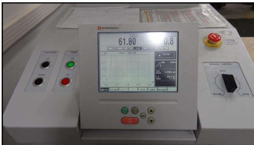
Figura 4.25 – Tela do dispositivo de controle do ensaio
