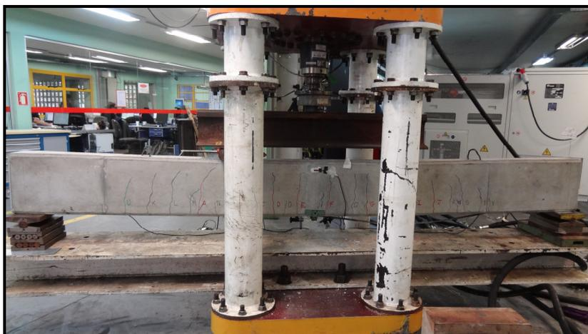
Figura 4.9 – Visão geral da VRE1 após ruptura
