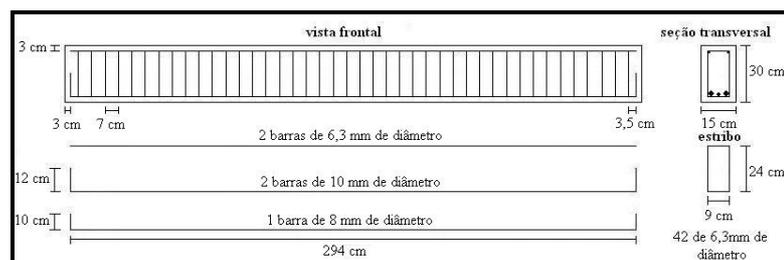
Figura 3.2 – Detalhamento das vigas testemunhos sub-dimensionadas (VTS1 e VTS2)
