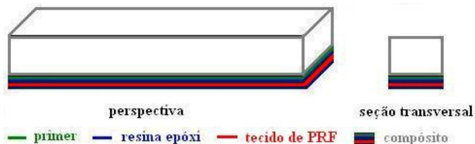
Figura 2.4 – Esquema de colagem externa de compósitos de tecidos de PRF
