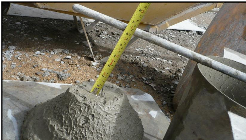
Figura 3.23 – Resultado de ensaio de abatimento de tronco de cone do concreto das vigas moldadas no primeiro dia
