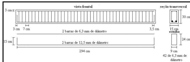
Figura 3.1 – Detalhamento das vigas testemunhos de projeto (VTP1 e VTP2)
