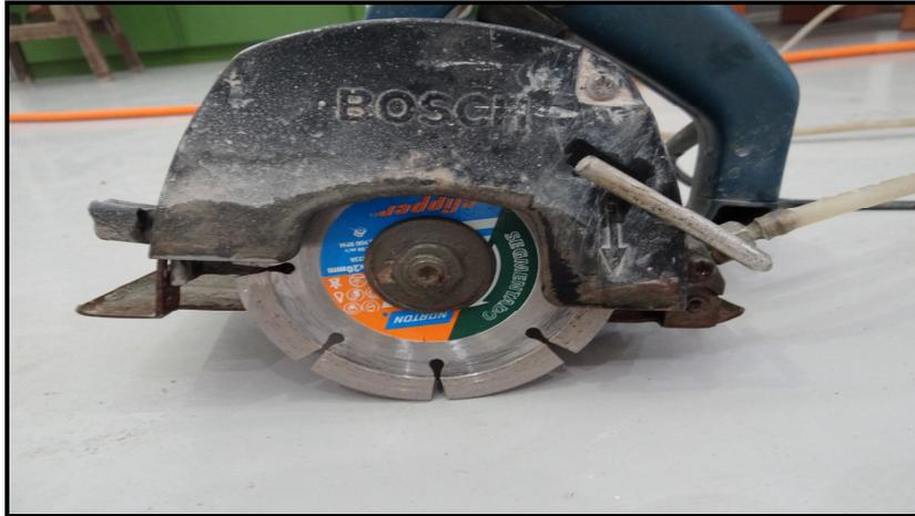
Figura 3.33 – Máquina de corte equipada com disco diamantado
