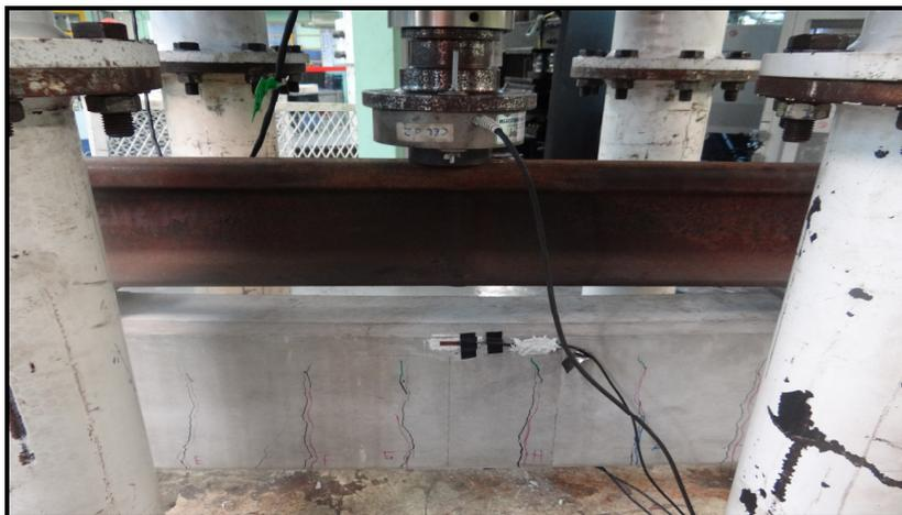
Figura 4.35 – Fissuras da VTS1 após ruptura
