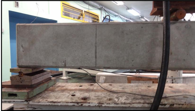
Figura 4.7 – Detalhe do descolamento dos dois laminados de PRFC da face inferior da VRE1
