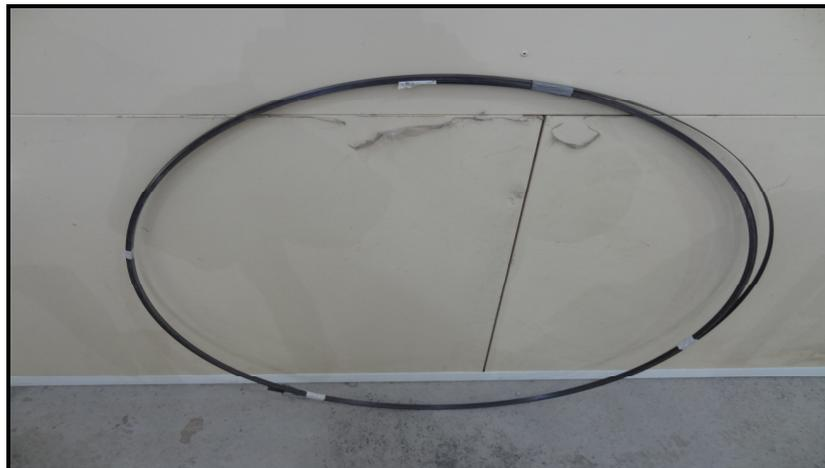
Figura 3.6 – Laminado de PRFC S&P *Laminates* CFK 150/2.000
