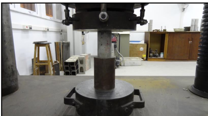
Figura 4.24 – Ensaio de compressão axial de um dos CPAs
