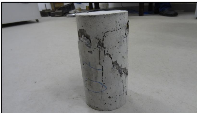
Figura 4.22 – Ruptura do CP7
