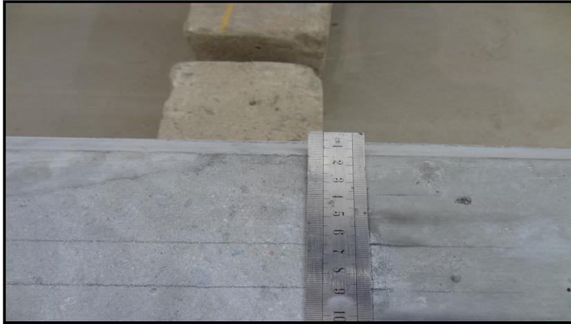
Figura 3.46 – Distância de 6,4 cm das faces superior e inferior para marcação da área real reforçada
