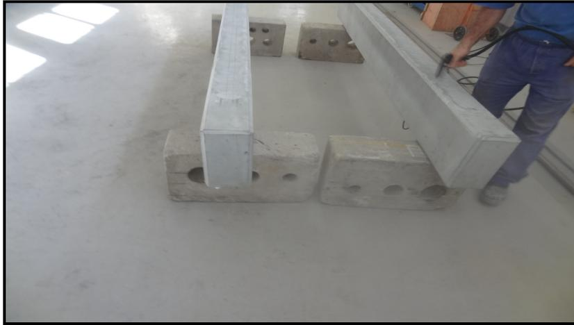
Figura 3.44 – Limpeza da superfície da VRE2 através da utilização de mangueira de ar comprimido
