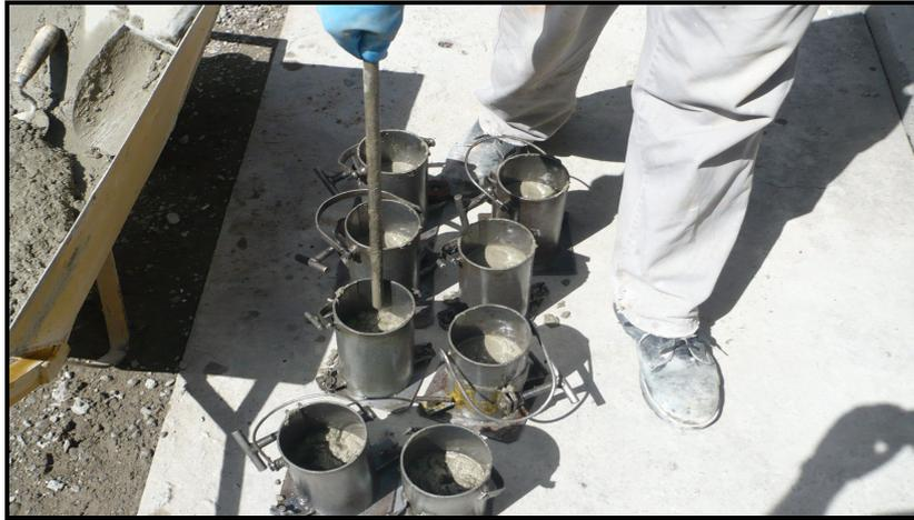
Figura 3.24 – Moldagem dos oito CPs do primeiro dia de concretagem das vigas
