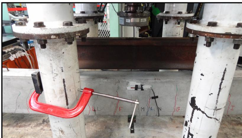
Figura 4.34 – Fissuras da VTP2 após ruptura
