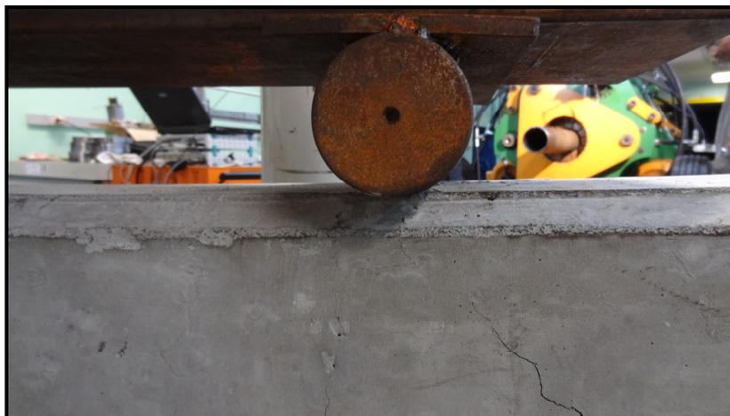
Figura 4.11 – Detalhe do esmagamento do concreto sob um dos pontos de carregamento da VRR1
