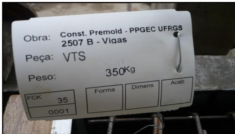
Figura 3.18 – Identificação da VTS-1 em papel preso a um arame trançado
