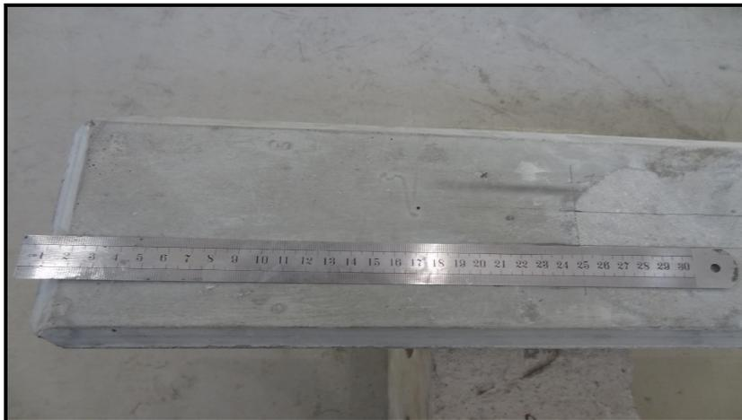
Figura 3.47 – Distância de 25 cm das faces de extremidade para marcação da área real reforçada
