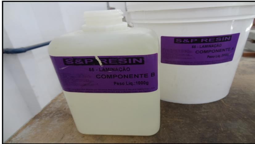
Figura 3.7 – Resina epóxi saturante S&P Resin 55
