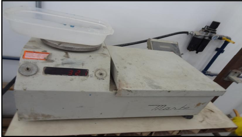
Figura 3.48 – Quantidade do componente A da resina epóxi medido na balança Marte com precisão de uma casa decimal
