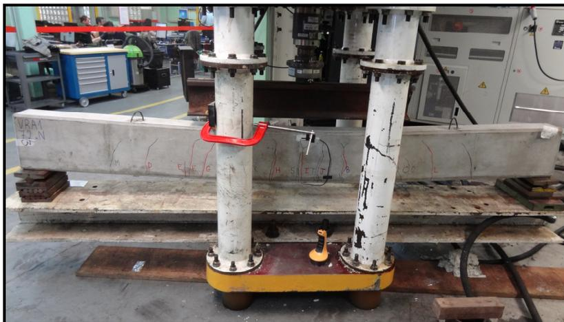
Figura 4.17 – Visão geral da VRA1 após ruptura
