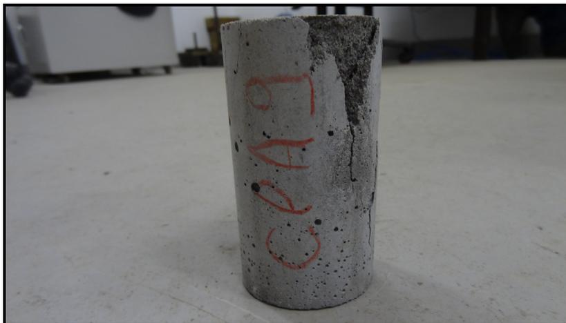
Figura 4.27 – Ruptura do CPA9
