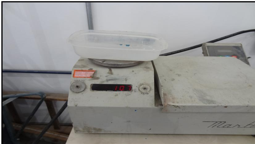
Figura 3.49 – Quantidade do componente B da resina epóxi
