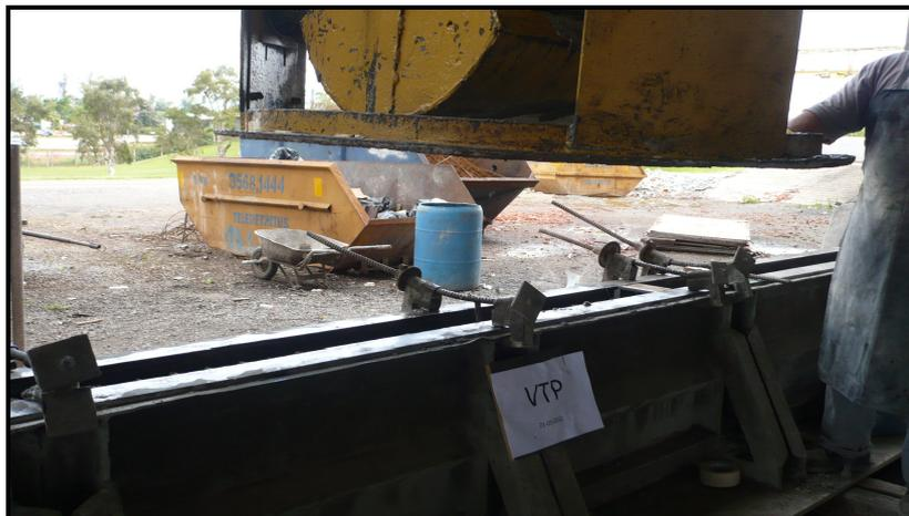
Figura 3.15 – Extenso molde formado por perfis de aço dividido em cinco volumes para concretagem das vigas pré-moldadas
