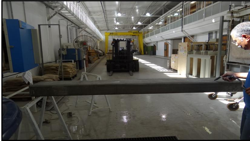
Figura 3.39 – Remoção com mangueira de ar comprimido do excesso de água da superfície da viga devido à lavagem
