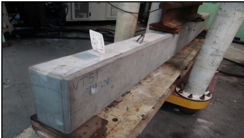
Figura 4.5 – Visão geral da VTS1 após ruptura
