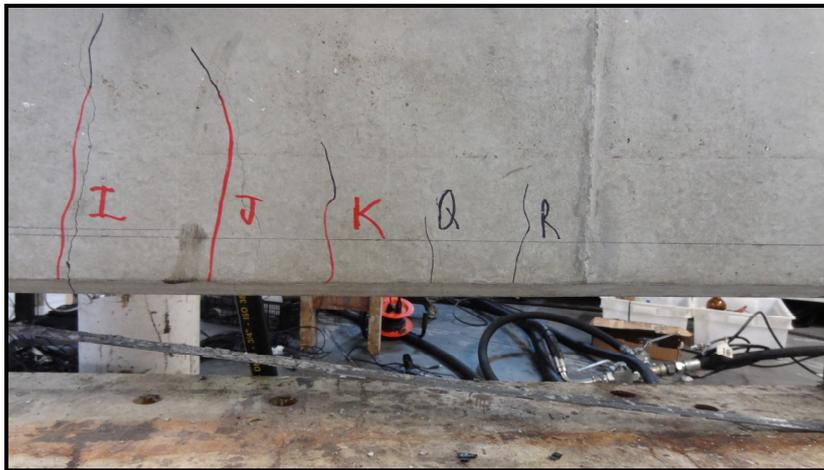
Figura 4.8 – Detalhe do descolamento dos dois laminados de PRFC da face inferior da VRE2
