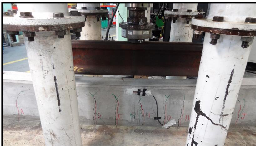
Figura 4.38 – Fissuras da VRA2 após ruptura
