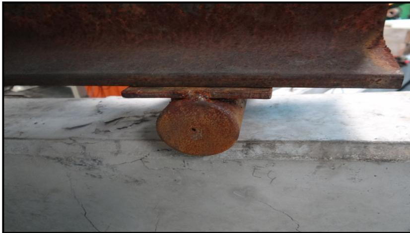
Figura 4.1 – Detalhe do esmagamento do concreto sob um dos pontos de carregamento da VTP1
