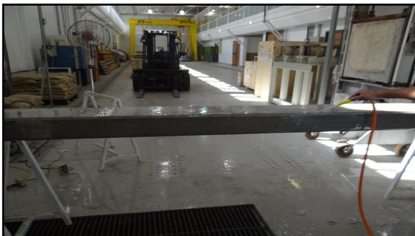
Figura 3.38 – Lavagem com mangueira de água das partículas de concreto do interior do entalhe e da superfície da viga devido ao corte
