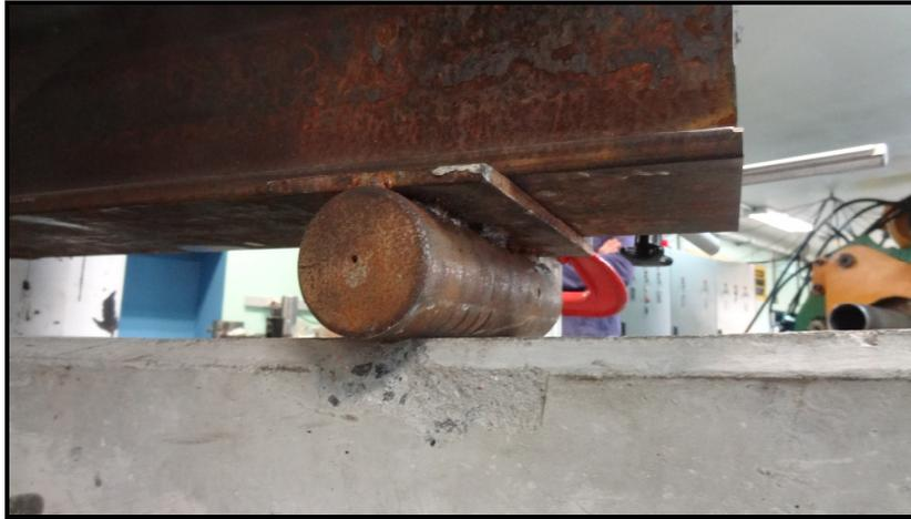
Figura 4.12 – Detalhe do esmagamento do concreto sob um dos pontos de carregamento da VRR2
