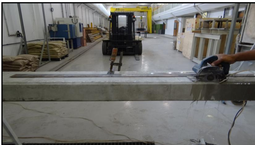
Figura 3.34 – Corte de uma ranhura em uma face da VRA1
