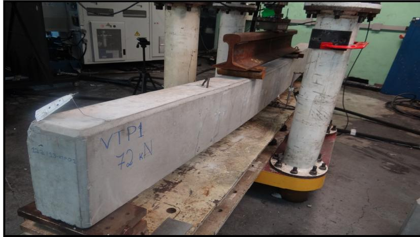
Figura 4.3 – Visão geral da VTP1 após ruptura
