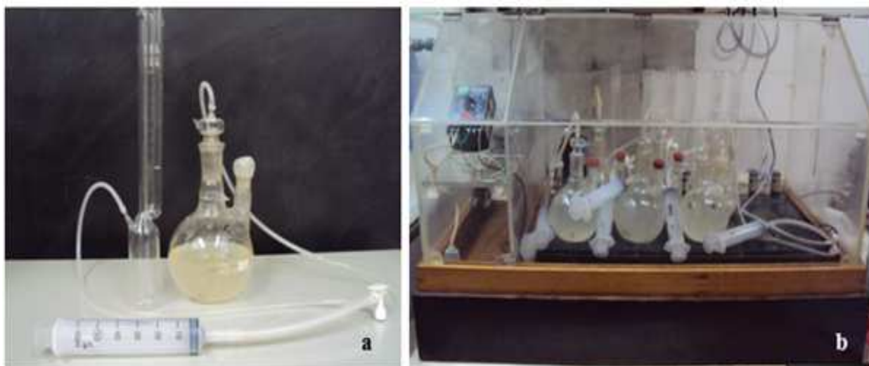
Figura 6: Sistema utilizado para a realização dos testes em batelada (a) Frasco de reação, manômetro e seringa para alívio de pressão e (b) caixa de acrílico para manutenção da temperatura e agitação constantes.
