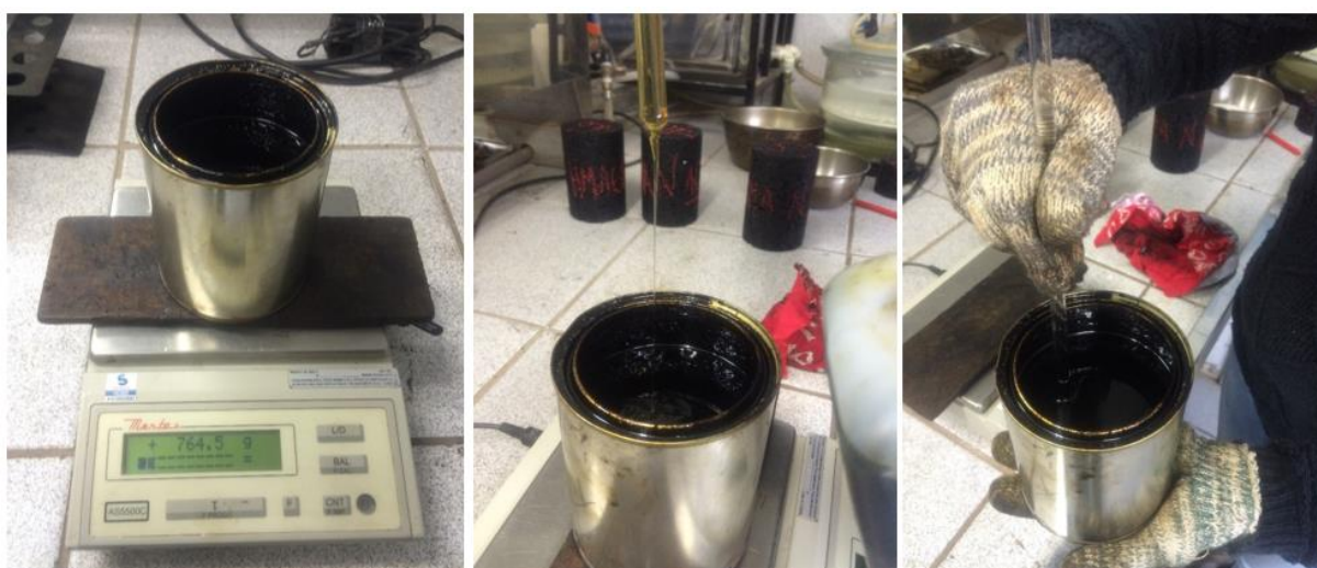
Figura 36: Incorporação do aditivo no CAP
