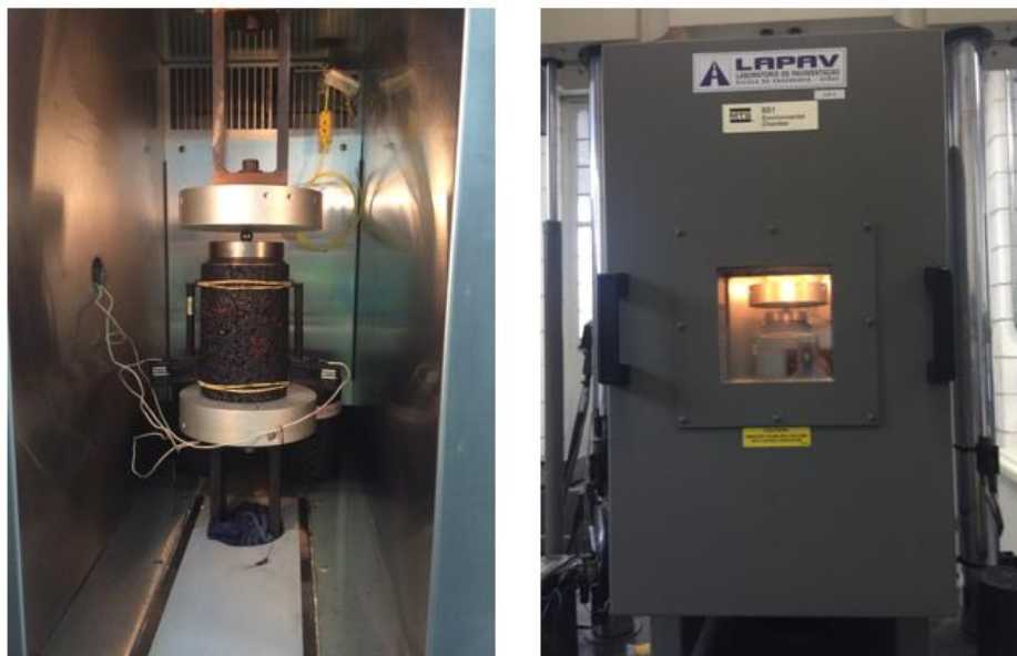
Figura 58: Amostra durante o EUCR
