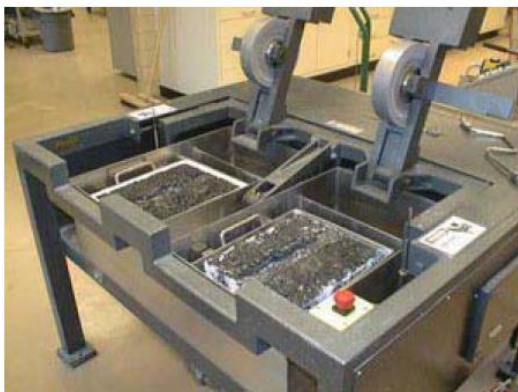
Figura 23: Simulador de tráfego de laboratório HWTD (adaptado de NASCIMENTO, 2010)
