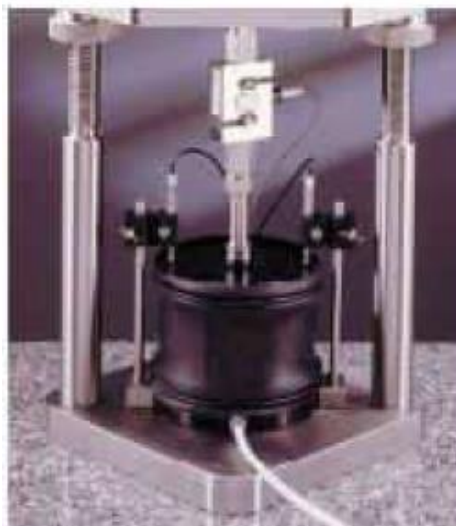
Figura 12: Ensaio de creep com confinamento (adaptado de MOURA, 2010)
