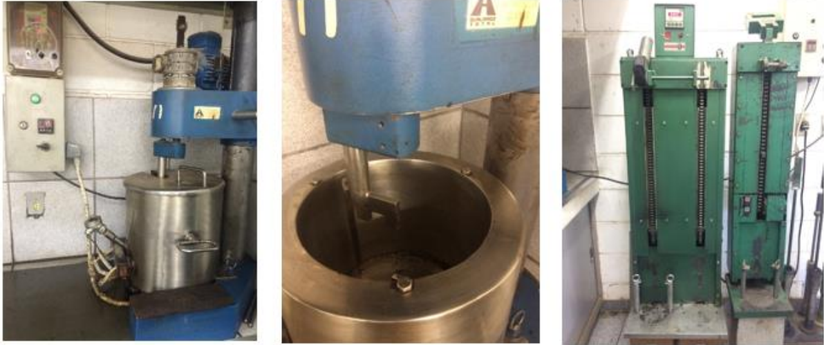
Figura 40: Equipamentos utilizados para usinagem dos CPs, cuba de usinagem e compactador automático.
