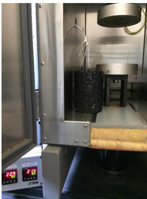
Figura A15 – CP para controle de temperatura
