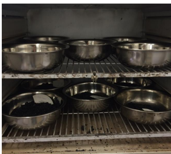
Figura 53: Misturas envelhecendo na estufa na temperatura de compactação por 2 horas
