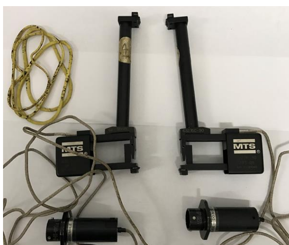
Figura 61: Extensômetros utilizados na pesquisa
