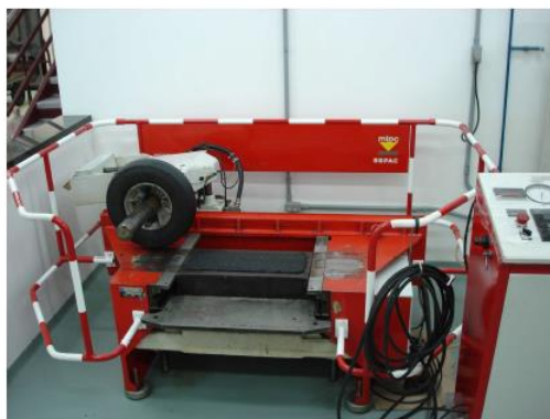
Figura 20: Mesa compactador - LCPC (adaptado de MOURA, 2010)
