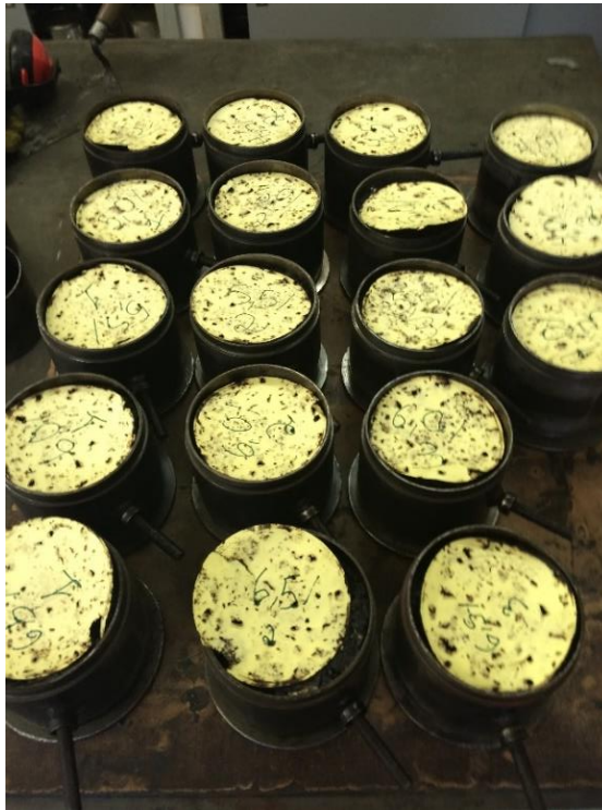
Figura 41: Corpos de prova compactados
