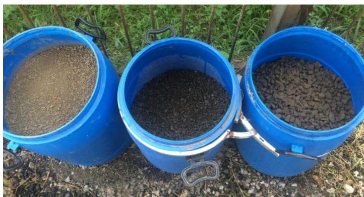
Figura 28: Agregados basálticos em três frações, pó-de-pedra, brita 3/8 e brita 3/4 respectivamente
