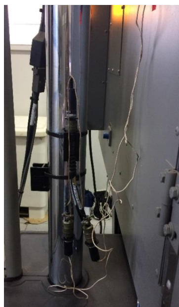
Figura A13 – Conexão dos sensores externos a câmara
