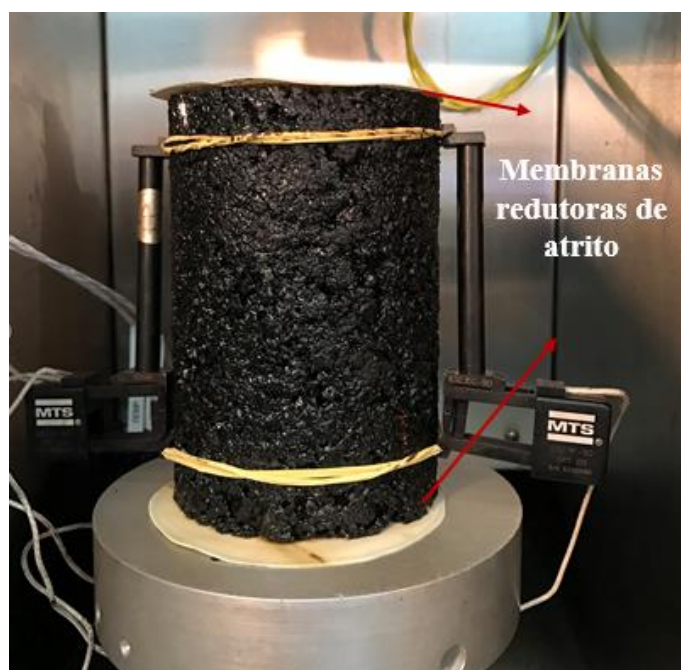
Figura 64: CP com membranas redutoras de atrito durante o EUCR – AASTHO TP -79
