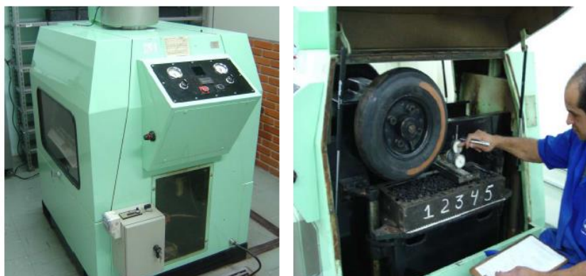
Figura 21: Simulador de tráfego francês (adaptado de MOURA, 2010)
