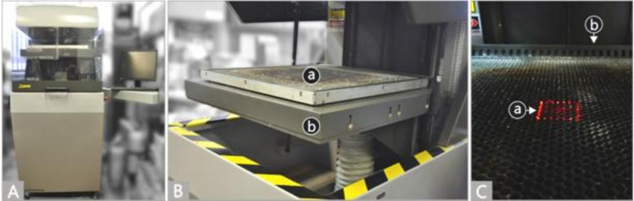
A - Máquina Mira 3007, vista frontal, B - parte interna da máquina, onde (a) indica a mesa de trabalho e (b) indica a plataforma móvel e C - (a) demarcação prévia da área a ser processada e (b) sistema de exaustão da máquina.
