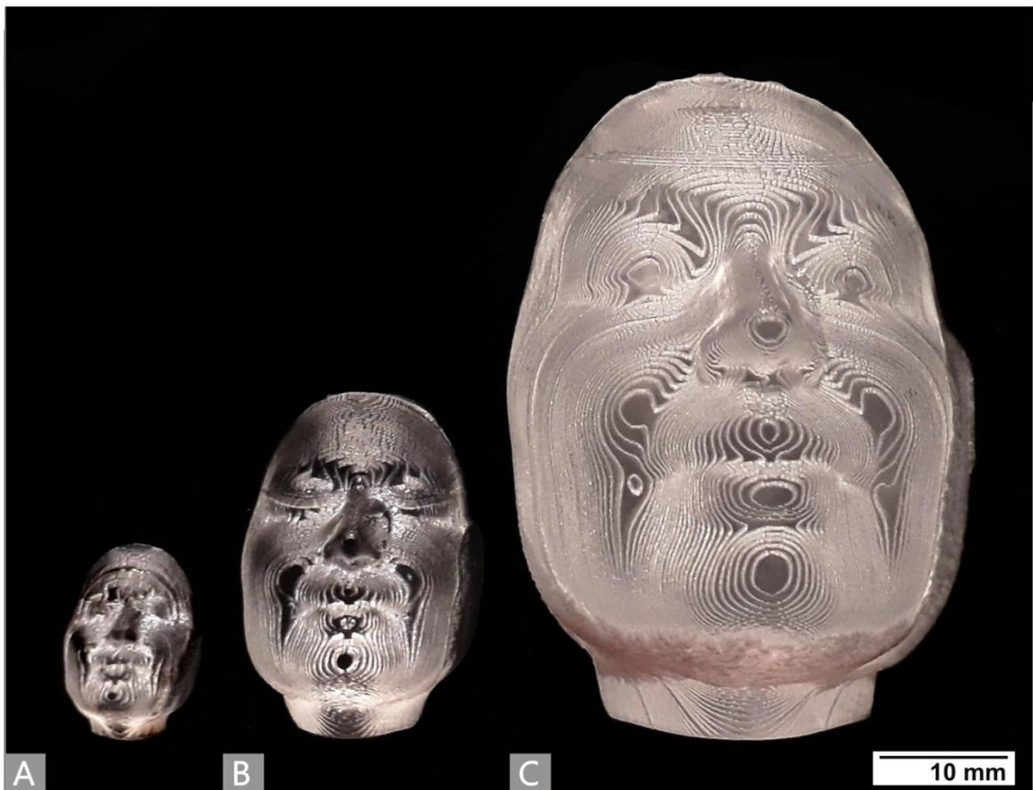
Rostos usinados com camadas de 0,2 mm de espessura, onde A - indica rosto usinado em chapa de 5,5 mm de espessura, B - indica rosto usinado em chapa de 10 mm de espessura e C - indica rosto usinado em chapa de 20 mm de espessura.
