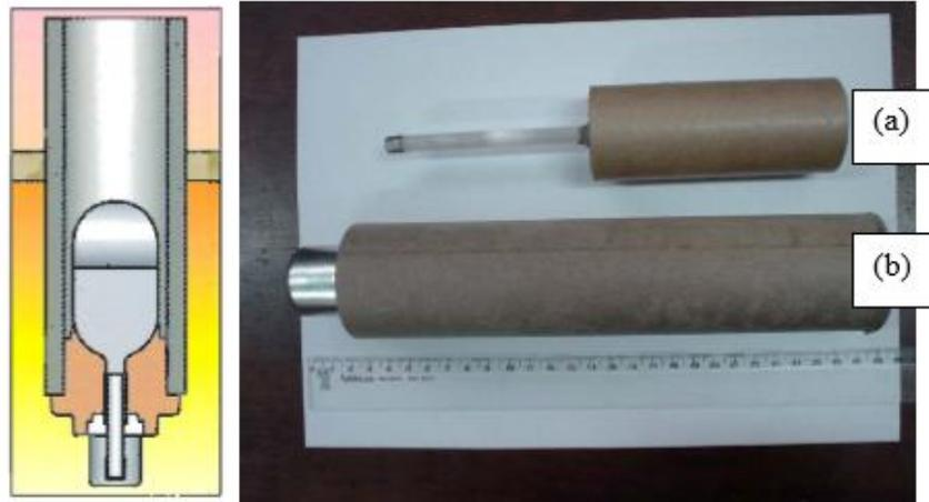
Figura 3.6 - Amostradores Samp-O-Line da Heraeus Electro-Nite utilizados para retirar amostras de aço. (a) Amostrador do forno-panela, (b) Amostrador do distribuidor (Fonte: BIELEFELDT, 2005)
