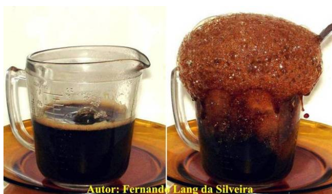
Figura 53 – A figura mostra café superaquecido no forno de microondas. A temperatura é superior ao ponto de ebulição do líquido embora ele não esteja fervendo. Quando uma colher é introduzida no recipiente contendo café superaquecido, ele irrompe em intensa ebulição, produzindo muita espuma.
