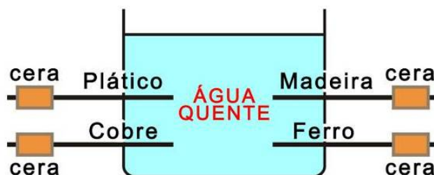
Figura 31 – A figura mostra um recipiente com água quente onde são colocadas quatro barras de materiais diferentes. Na extremidade das barras coloca-se um pedaço de cera.
