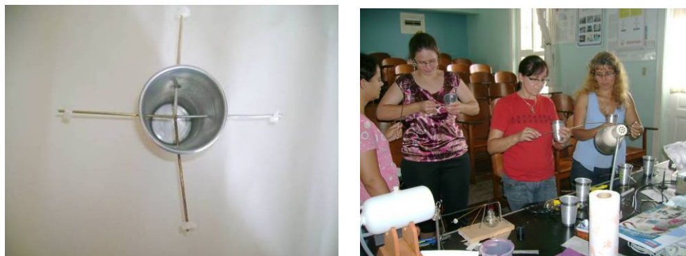
Figura 6- (a) Dispositivo construído para mostrar a transmissão de calor por condução nos diferentes materiais. (b) Alunos trabalhando na construção do dispositivo.
