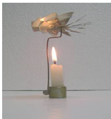
Figura 33 – A figura mostra um cata-vento girando devido às correntes de convecção.
