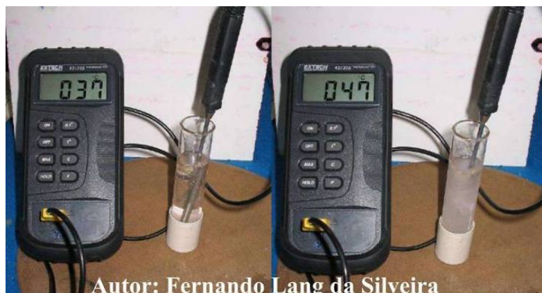
Figura 52 - Tiosulfato de sódio em estado de superfusão a 37°C e cerca de meio minuto depois, parcialmente cristalizado a 47°C.
