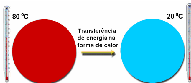
Figura 1- A energia na forma de calor flui espontaneamente do corpo de maior temperatura para o corpo de menor temperatura.
