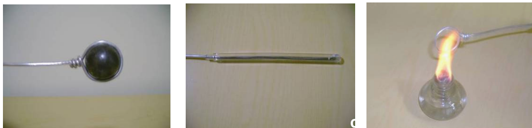
Figura 3 – Dispositivo construído para mostrar a dilatação de um anel. (a) A esfera não passa pelo anel. (b) Extremidade isolada com o plástico de uma caneta. (c) O anel sendo aquecido.
