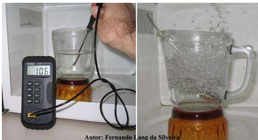
Figura 54 – A Foto mostra a água superaquecida no forno de microondas, isto é, 6° C acima do seu ponto de ebulição sem ferver. Quando a água superaquecida é perturbada (neste caso jogou-se uma colher para dentro do recipiente), irrompe em intensa ebulição.
