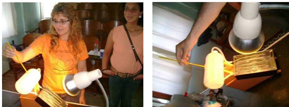
Figura 9 – Alunos verificando a variação de temperatura que ocorre no reservatório de água no protótipo do aquecedor solar.
