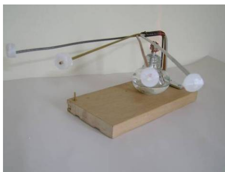
Figura 7- Dispositivo construído para mostrar a transmissão de calor por condução nos diferentes materiais.
