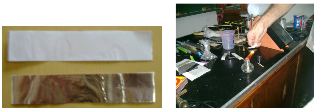
Figura 5- (a) Lâminas bimetálicas construídas pelos alunos e sua (b) utilização.
