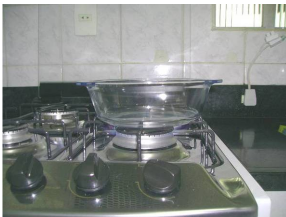
Figura 21 – O vidro pirex tem um coeficiente de dilatação relativamente pequeno, por isso pode ser colocado diretamente no fogo.
