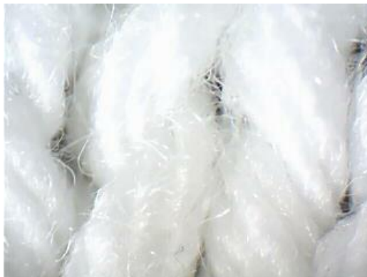
Figura 34 - Tecido de lã ampliado 20 vezes.
