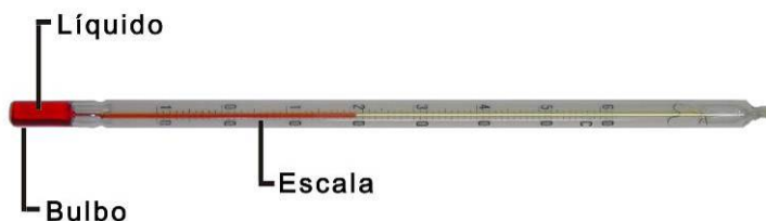
Figura 7 – Termômetro de álcool com capilar evacuado.
