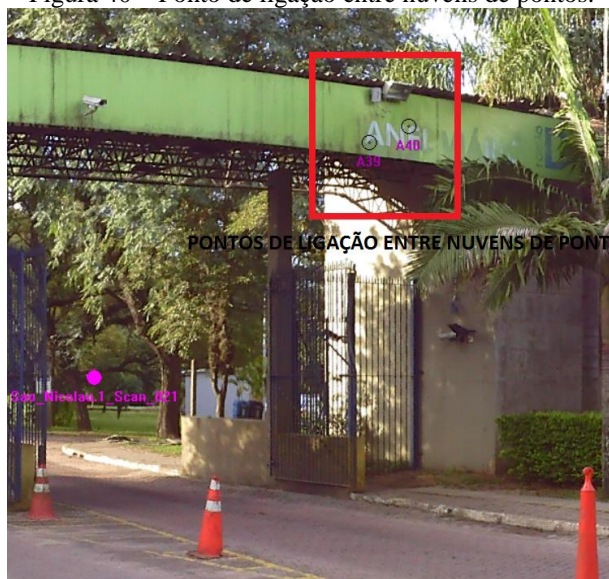
Figura 40 – Ponto de ligação entre nuvens de pontos.
