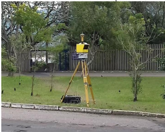
Figura 47 – Georreferenciamento de nuvens de pontos no SVLT Optech.
