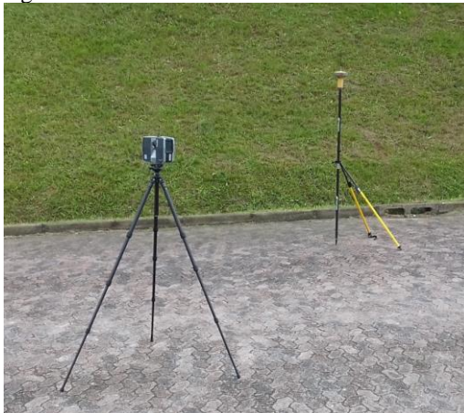
Figura 42 - Georreferenciamento do SVLT Faro.
