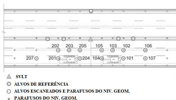
Figura 25 – Medições envolvendo SVLT e Nivelamento Geométrico (NG).
