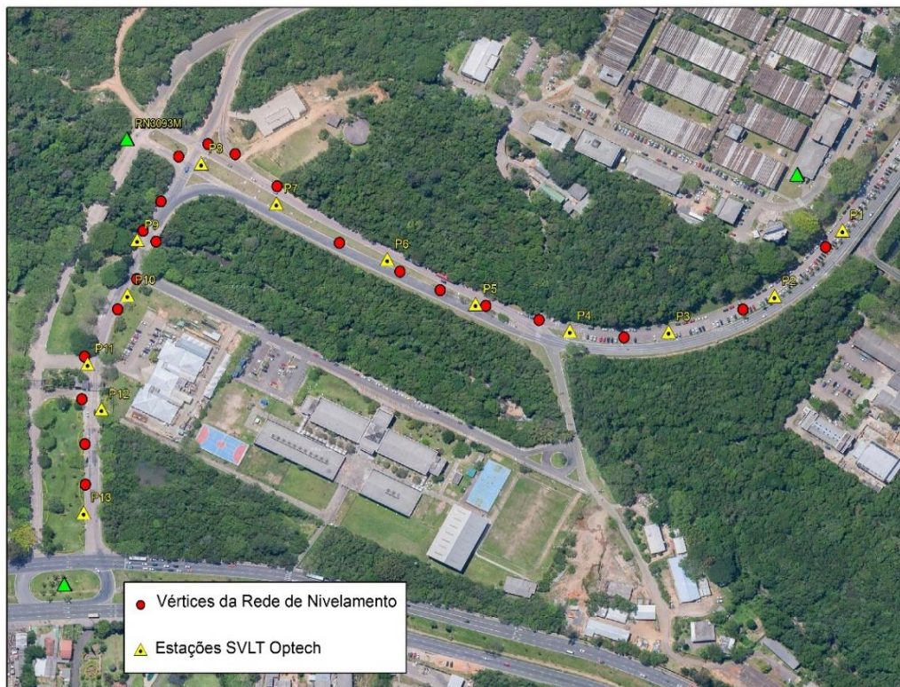
Figura 39 - Estações de escaneamento do SVLT Optech.
