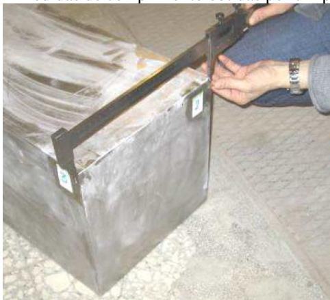
Figura 26 – Medidas de comprimento obtidas por um paquímetro.
