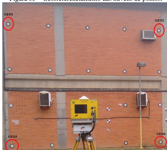
Figura 35 – Georreferenciamento das nuvens de pontos.
