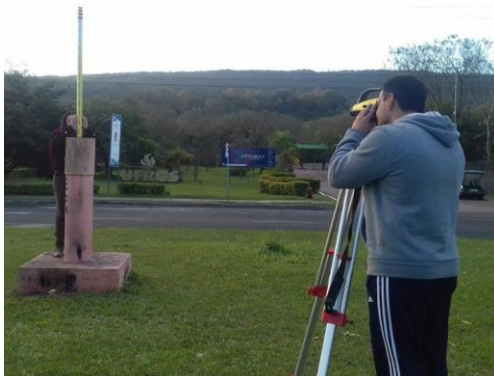
Figura 51 – Nivelamento geométrico – marco M17.
