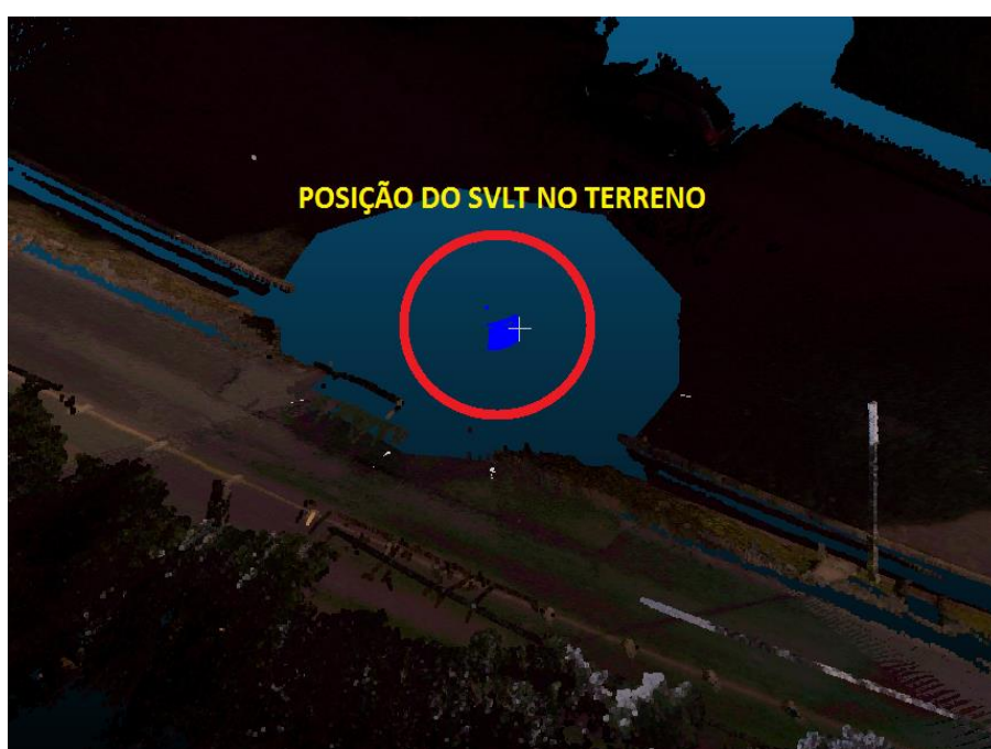
Figura 49 – Posição do SVLT Optech na nuvem de pontos.
