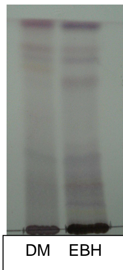
Figura 8. CCD da fração diclorometano (DM) e do extrato bruto (BRU). Fase móvel: Diclorometano:Metanol (95:5 v/v). Agente cromogênico: anisaldeído sulfúrico com posterior aquecimento a 100°C.
