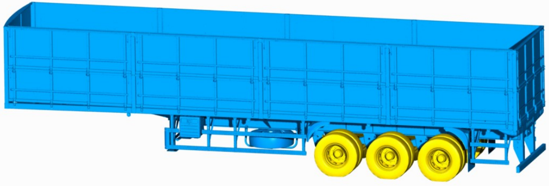
Figura 25 - Componentes de massa suspensa (azul) e massa não-suspensa (amarelo)
